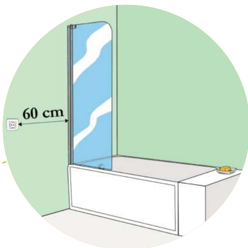
Figura 14: a tomada deve estar a mais de 60 centímetros do bordo da banheira
