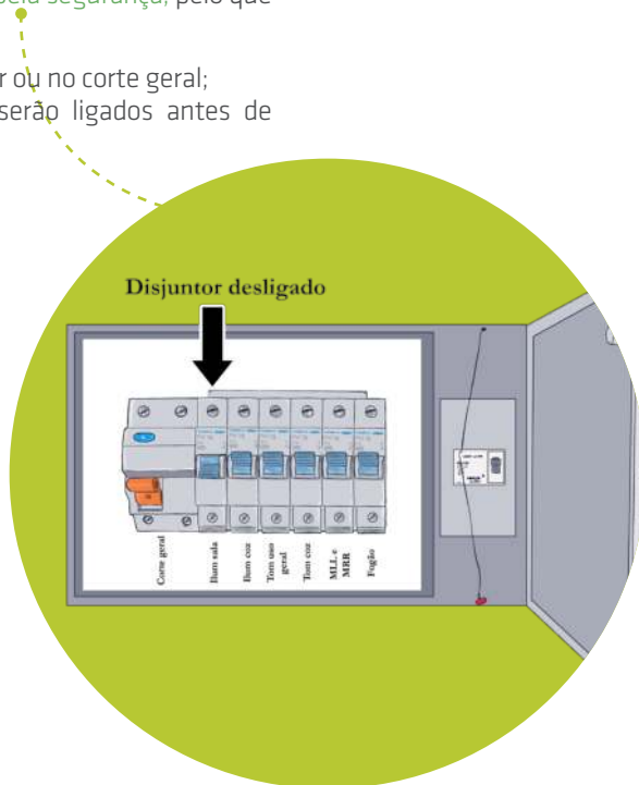
Figura 28: quadro com disjuntor do circuito em manutenção (iluminação da sala) desligado
