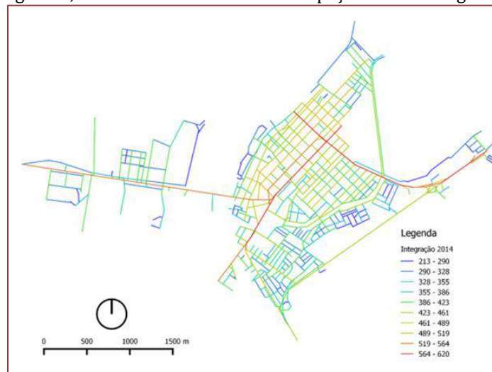
Figura 16: Mapa de integração da cidade de Icó/CE. As cores mais quentes indicam espaços mais integrados, as cores mais frias indicam espaços menos integrados.
