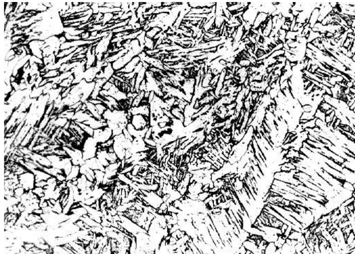
Figura 5.25. Microestrutura da ZF obtida na soldagem GMAW de um aço baixo carbono com 0,70% Mn e 0,32% Si. 200x. Ataque: Nital.
