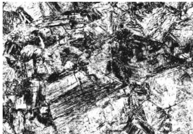
Figura 2.22. Microestrutura de um aço baixo carbono constituída basicamente de bainita e martensita (fundo claro). Ataque: Nital. 200x.
