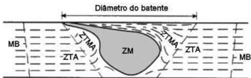
Figura 3.33. Macroestrutura esquemática da seção transversal de uma solda FSW (3.21) . MB – Metal base, ZTA – Zona termicamente afetada, ZTMA – Zona termomecanicamente afetada e ZM – Zona misturada (“Nugget”, região que passa pela deformação mais severa e pelo deslocamento do material devido ao movimento de rotação da ferramenta).
