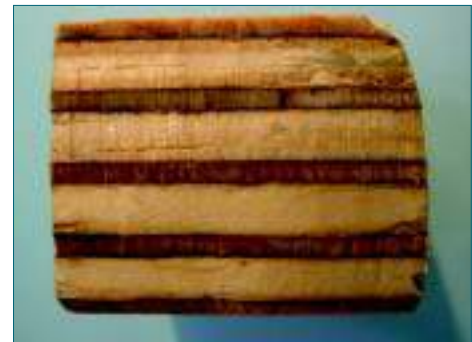
Fig 1.1 - Compensado de madeira com várias camadas de madeira laminada colada e com orientação do veio cruzada em cada camada.
