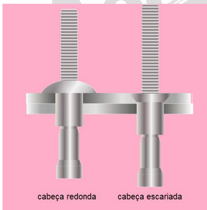
Fonte: FAA - Federal Aviation Administration - Mechanic Training Handbook Figura 6-35 Rebites de auto-cravação (Travados por atrito).
