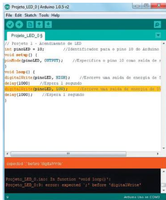
Figura 27 – Mensagem de erro de compilação ( http://arduino.cc ).
