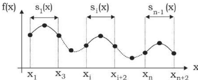
Figura 4.2. Interpolação por parte – *splines*.
