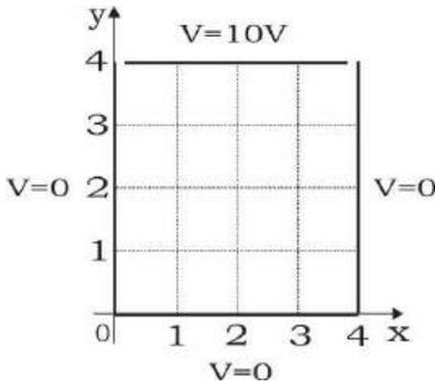
Se o problema for dividido da forma como ilustrado, tem-se 9 pontos de malha. Para cada um desses 9 pontos deve-se formular uma equação, conforme apresentado.
