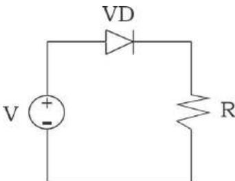
Admitindo um diodo de silício próximo da idealidade, sua queda de tensão é de 0,7 V.
