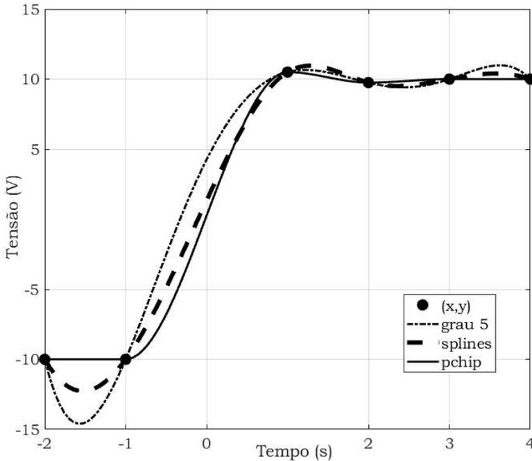
O Matlab possui uma função nativa chamada *interp1*, que possibilita escolher o método de interpolação a ser utilizado. A curva em linha contínua foi obtida com o método *pchip* – interpolação cúbica hermitiana por partes.
