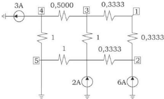
$$\begin{Bmatrix} 0 \\ 6 \\ 0 \\ 2 \\ -3 \end{Bmatrix} = \begin{bmatrix} 6 & -3 & -3 & 0 & 0 \\ -3 & 6 & 0 & -3 & 0 \\ -3 & 0 & 6 & -1 & -2 \\ 0 & -3 & -1 & 5 & 0 \\ 0 & 0 & -2 & 0 & 3 \end{bmatrix} \begin{Bmatrix} V_1 \\ V_2 \\ V_3 \\ V_4 \\ V_5 \end{Bmatrix} .$$
