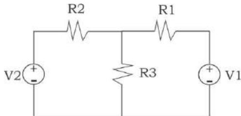
$$\begin{bmatrix} 20 & 10 \\ 10 & 20 \end{bmatrix} \begin{Bmatrix} I_1 \\ I_2 \end{Bmatrix} = \begin{Bmatrix} 100 \\ 100 \end{Bmatrix}.$$
