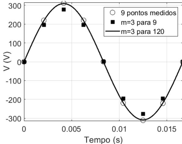
Com  $m = 1$  ou  $3$ , os valores calculados são próximos e apresentam um erro considerável quanto à amplitude do sinal. Lembrando que  $m = 3$  é o limite imposto por  $N > 2m + 1$ .
