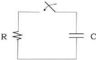
$v(t) = V_0 e^{-t/\tau}$ ,  $t \geq 0$  onde  $V_0$  é a tensão inicial no capacitor e  $\tau$  é a constante de tempo para o circuito, dado por  $\tau = RC$ . Sendo a corrente obtida por  $i(t) = v(t)/R$ , pode-se calcular a potência da seguinte forma:
