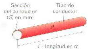
**Resistividad ( $\rho$ ):** Es característica de cada material y se define como la resistencia que ofrece al paso de la corriente un conductor de un material determinado de 1 metro de longitud y 1 mm<sup>2</sup> de sección.
