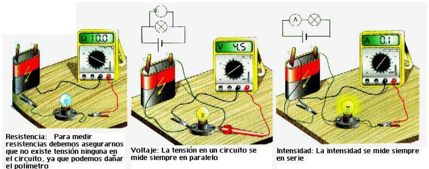
**Resistencia:** Para medir resistencias debemos asegurarnos que no existe tensión ninguna en el circuito, ya que podemos dañar el polímetro
