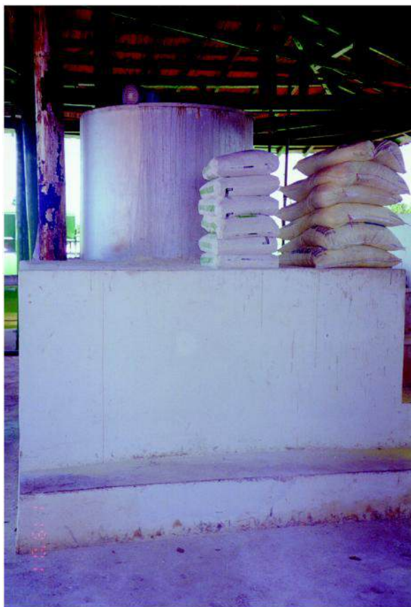
Figura 11 - Equipamento (caldeira) para a fabricação da calda sulfocálcica, utilizada no controle de insetos nocivos.
