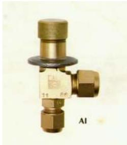
Esta válvula mantém constante a pressão na sua descarga, à entrada do evaporador. Usada nas instalações menores de 30 KW. As válvulas automáticas se destinam a manter uma pressão de sucção constante no evaporador, independente das variações de carga de calor. São válvulas de funcionamento muito preciso. Uma vez bem reguladas, mantêm praticamente
