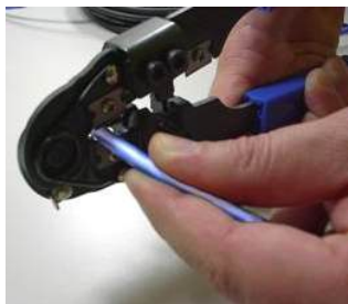
Figura 3.16 - Descascando o cabo
