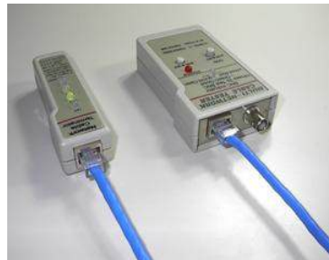
Figura 3.18 - Testando cabos RJ-45
