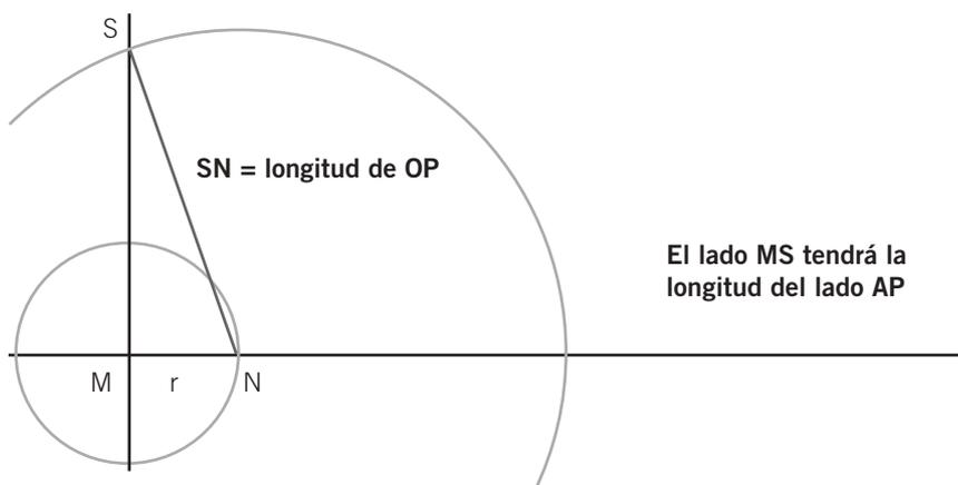
Una vez realizada esta construcción, con la medida  $MS$  como radio pueden marcarse con el compás, centrado en  $P$ , los puntos  $A$  y  $A'$  de intersección con la circunferencia. Esta construcción permite validar que por  $P$  pasan siempre dos rectas tangentes a la circunferencia.
