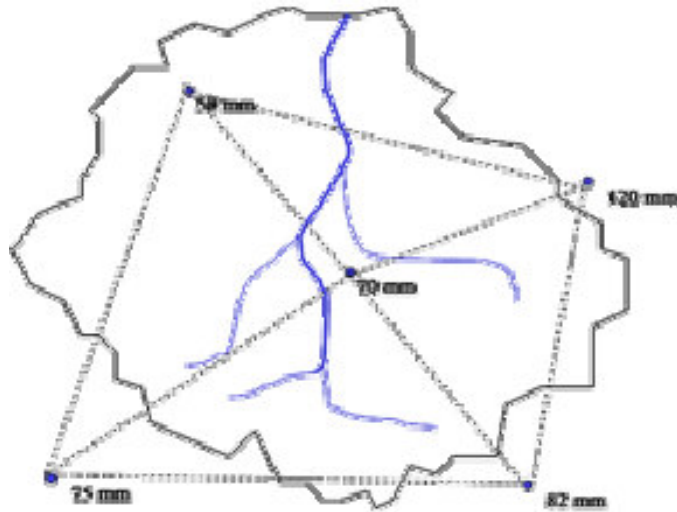
Figura 23: Traço de linhas unindo postos pluviométricos de uma bacia hidrográfica (UFRRS)
