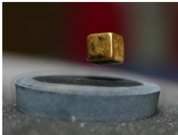
Figura 3.13.: Levitação magnética de um ímã cúbico sobre um disco de material supercondutor.
