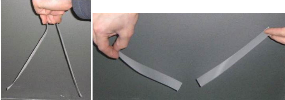
Figura 1.1.: Força repulsiva entre pedaços de fita cola com cargas do mesmo sinal, e força atrativa entre pedaços com cargas de sinais opostos.
