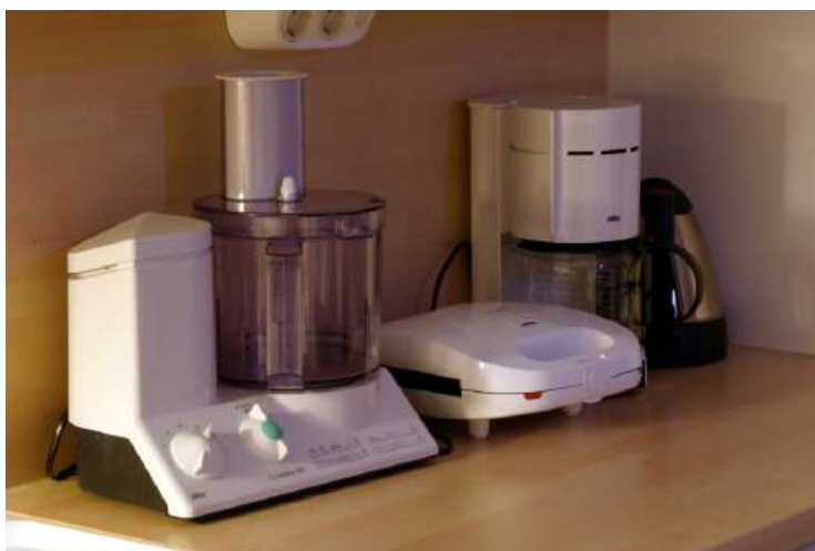
Figura 3.4.: A resistência de cada eletrodoméstico é igual ao quadrado da diferença de potencial à qual deverá ser ligado, dividido pela sua potência nominal.
