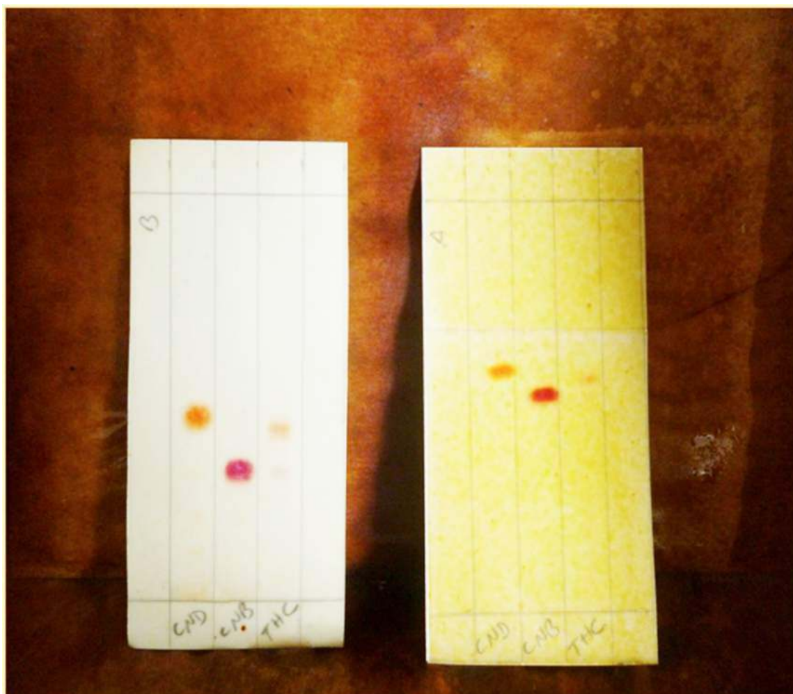
Figura 2. Cromatografia em camada delgada (raias de 1 cm x 8 cm) utilizando sistemas A e B nas condições propostas (CND – canabidiol, CNB – canabinol e THC – tetrahydrocanabinol).
