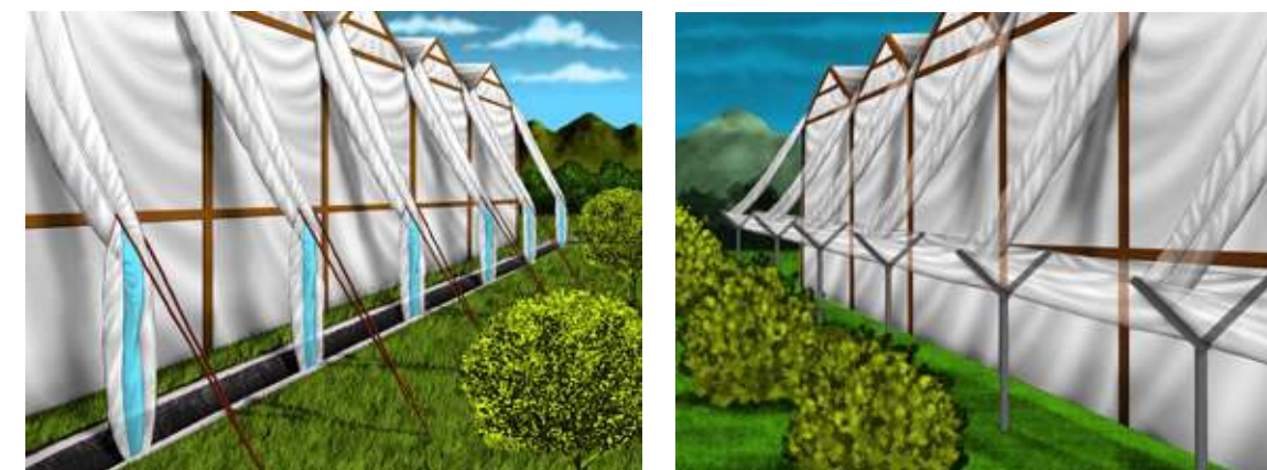
Figura 15 Vallado de recolección de aguas lluvia y canal aéreo para la recolección de aguas lluvia
