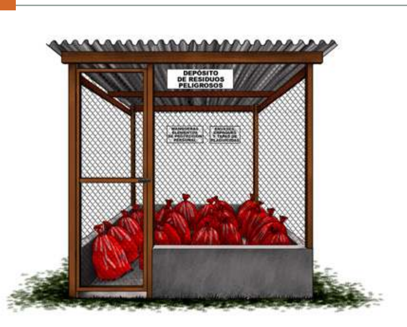
Figura 31 Depósito de residuos peligrosos
