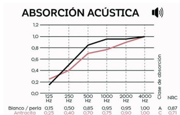
Figura 31 Datos absorción acústica láminas BASIC. Fuente: SERINAC
