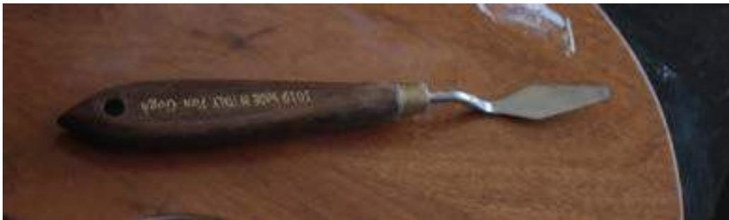
flexibilidade. Evite espátulas de plástico pela baixa flexibilidade, resistência, dificuldade de limpeza e durabilidade.
