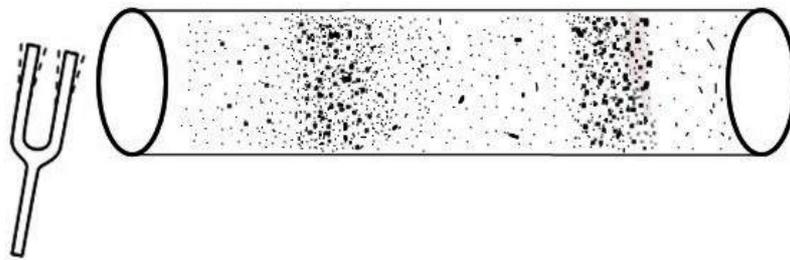
Figura 2.14. Ondas longitudinales que se propagan a lo largo de una columna de aire en un tubo con superficie de vidrio, para localizarlas mejor y evitar su disipación. El diagramador dibujó algunas *partículas* de aire demasiado grandes, lo que facilita imaginar lo que ocurre en otras circunstancias. Las ondas sonoras se generan mediante las vibraciones de un diapasón de la frecuencia que se desee.
