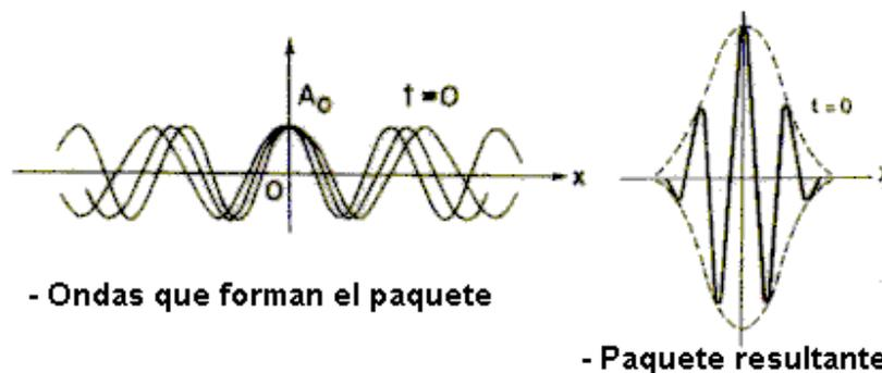
Figura 2.5. Paquete de ondas. a) Superposición de muchas ondas planas. b) Superposición de 3 ondas. (Esta última fue tomada de UAM (Universidad Autónoma de México), Iztapalapa: [http://luz.izt.uam.mx/mediawiki/index.php/Paquete\\_de\\_Ondas](http://luz.izt.uam.mx/mediawiki/index.php/Paquete_de_Ondas))
