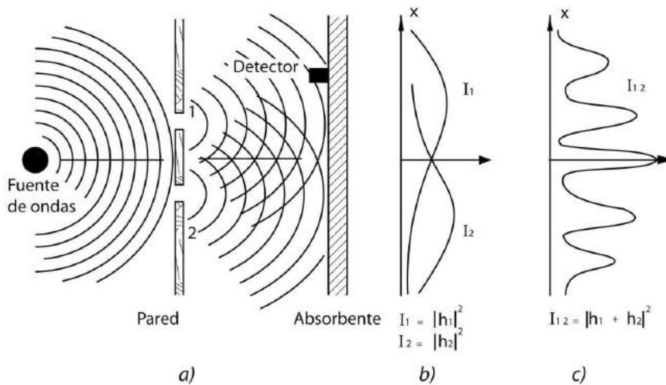
Figura 3.15. Esquema del experimento con ondas en un cubilete de agua.
