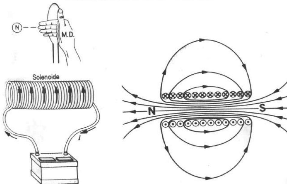
Figura 2.24. Un solenoide por el que se hace circular una corriente estacionaria (constante, denominada también *corriente directa*, c.d.) por medio de una pila o batería o cualquier otro tipo de fuente de c.d. A la derecha se ilustran las líneas de campo, resultado de la superposición de varias espiras como la de la figura 2.22b.
