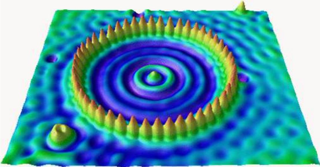
Figura 3.10. Micrografía de tunelamiento y barrido, lograda con el STM, mostrando las ondas electrónicas que aparecen cuando 48 átomos de Fe se sitúan formando un círculo sobre una superficie de cobre. En realidad, lo que se está midiendo con el experimento es la *amplitud de probabilidad* (siguiente capítulo). Para más detalles, véase el libro ya referido sobre *Nanotecnociencia*. (Figura tomada de la página de IBM; se muestra y explica en muchos textos de física general.)
