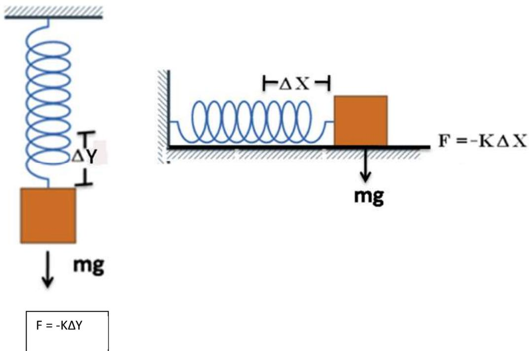
Figura 2.10 a) Oscilador vertical. b) Oscilador horizontal. La característica común es que la fuerza recuperadora es proporcional a la deformación, lo cual es válido en primera aproximación, vale decir, si la deformación es pequeña. En el primer caso, el peso  $mg$  es compensado por una deformación inicial; en el segundo, por la fuerza normal. Se supone que las fuerzas de roce y de fricción con el aire son pequeñas comparadas con la fuerza elástica debida al resorte.
