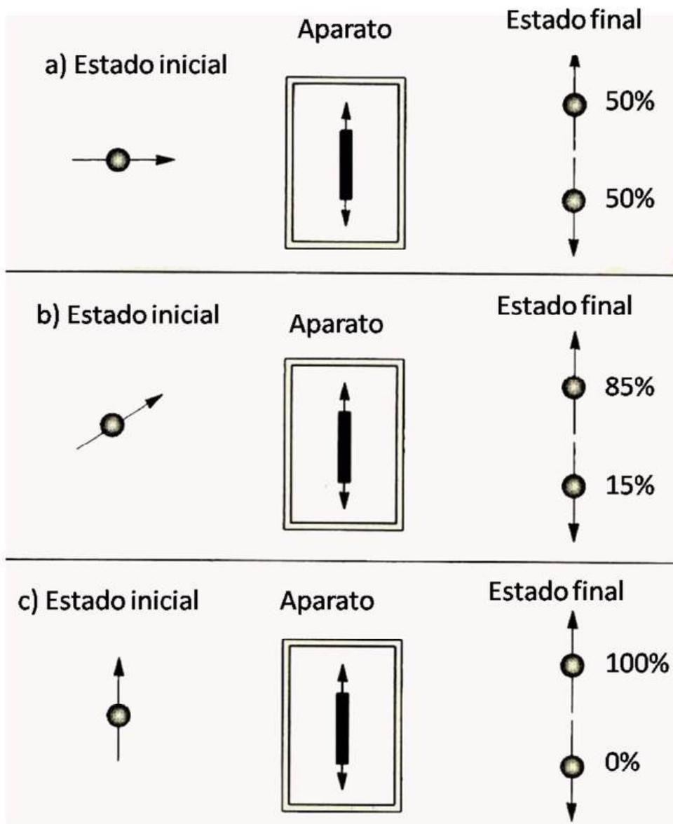
Figura 3.13. Aparato Stern-Gerlach vertical *fijo* que examina electrones preparados inicialmente en distintos estados de espín. a) Preparación inicial con espín horizontal. b) Preparación inicial con espín oblicuo. c) Preparación inicial con espín vertical.
