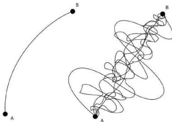
Figura 1.5. a) Richard P. Feynman (1918-1988); b) Esquema del método de las *integrales de camino*: diversas trayectorias seguidas por un electrón cuando va de A a B; la trayectoria que seguirá, mientras no se le observe es la superposición de todas las posibles, es decir, *ninguna*.
