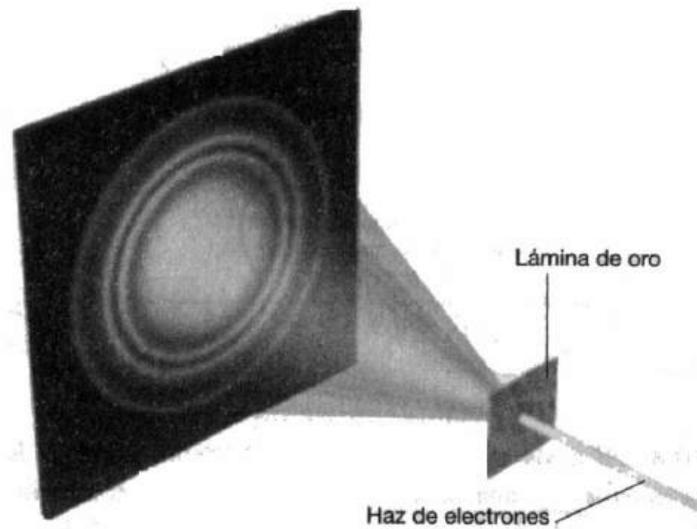
Figura 3.9 b) Esquema del experimento de Thomson, mediante el cual, haciendo incidir electrones sobre una fina lámina de oro, se obtiene un patrón de difracción, característico del comportamiento ondulatorio.
