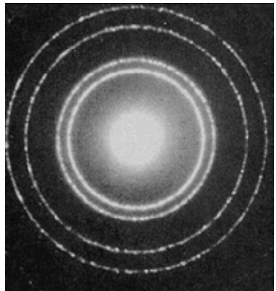
Figura 3.9 a) Comparación de los patrones de difracción de rayos X y de electrones al atravesar una delgada lámina de aluminio.
