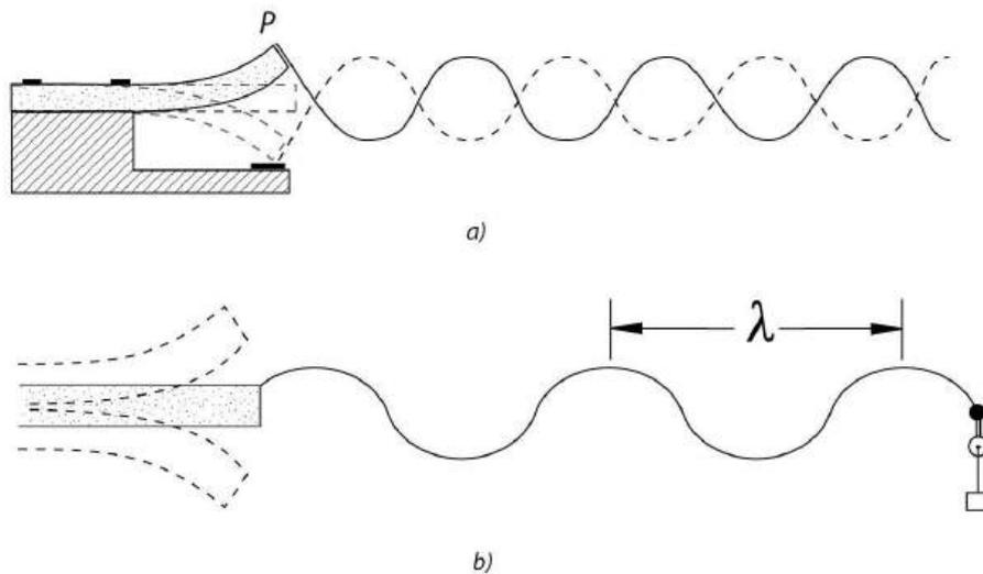
Figura 2.13. Ondas estacionarias en cuerdas, generadas mediante diapasones de diferentes frecuencias. La velocidad de propagación de la onda está determinada por la densidad (masa por unidad de longitud) de la cuerda y por la tensión a que está sometida. En la figura a) la cuerda está libre por el extremo derecho. En la b) el peso tensiona la cuerda: hay que ajustar el valor del peso para formar una onda estacionaria.
