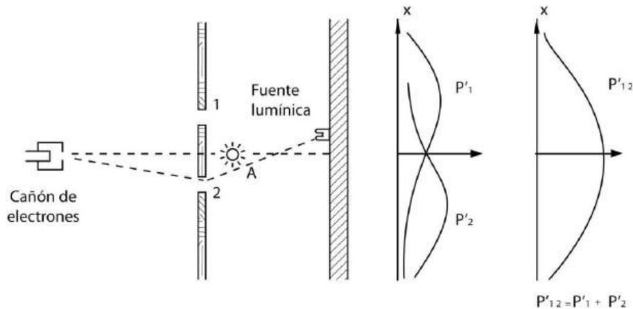
Figura 3.17. Observando (espionando) el paso de los electrones.
