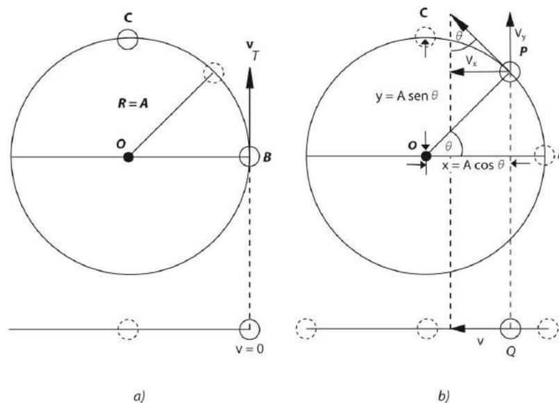
Figura 2.12. El movimiento circular uniforme se puede visualizar como la superposición de dos movimientos armónicos simples, uno en dirección  $x$ , otro en dirección  $y$ , *desfasados* en  $\pi/2$ .
