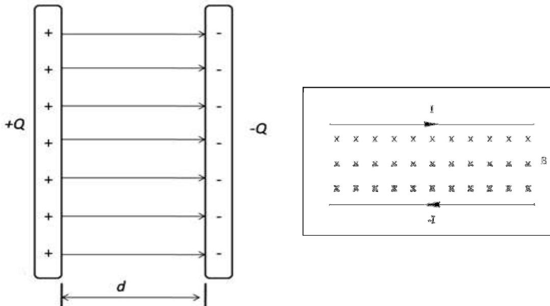
Figura 2.28. Campos producidos por placas paralelas ilimitadas. Se muestra solo una región de las placas. a) Campo de placas cargadas con cargas iguales y opuestas. b) Campo magnético producido por un par de placas que transportan corriente en direcciones opuestas.
