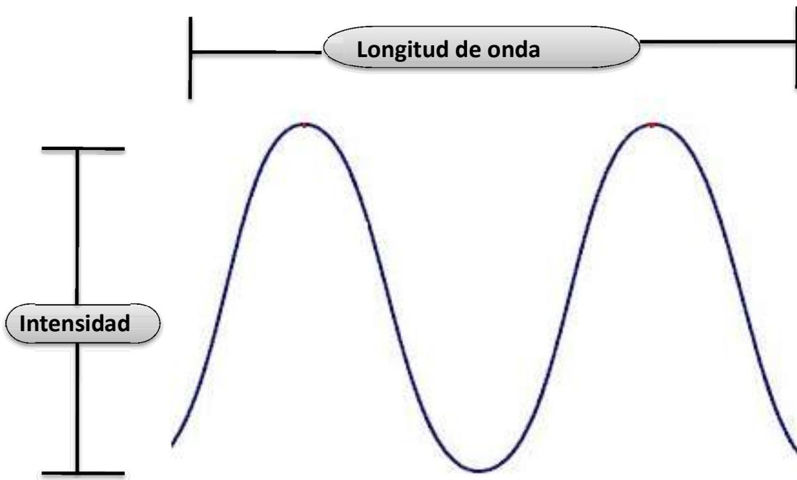
Figura 2.4. Ilustración espacial de la intensidad de una onda matemática en una dimensión. (La intensidad de la onda es proporcional al cuadrado de la amplitud, por ende siempre es una cantidad positiva. En cuanto a la amplitud, la gráfica sería el ciclo completo de una senoide.)
