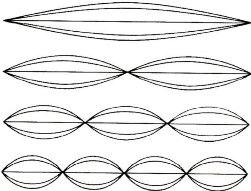
Figura 2.17. Ondas estacionarias en una cuerda fija por sus dos extremos. En el primer caso,  $L = \frac{1}{2} \lambda$ ; en el segundo,  $L = \lambda$ ; en el tercero,  $L = (3/2) \lambda$ ; para el cuarto,  $L = 2\lambda$ .
