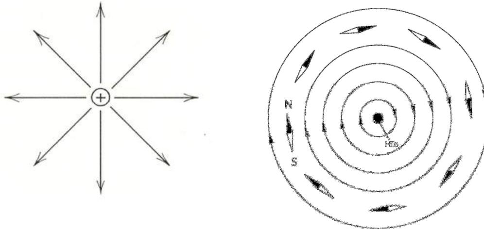
Figura 2.27. Sección transversal de los campos de líneas de carga y de corriente. a) Campo eléctrico de una línea recta cargada; b) campo magnético de una línea de corriente, segmento recto muy extenso, en dirección entrante a la hoja.
