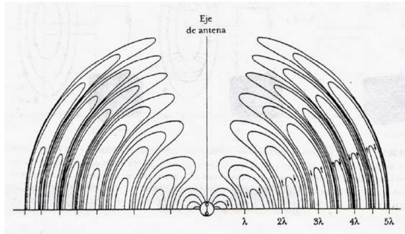
Figura 2.31 Campo variable de un dipolo eléctrico. A grandes distancias, las ondas electromagnéticas forman ondas planas, como sugiere la figura 2.16. (Tomado de Panofsky y Phillips: *Classical Electricity and Magnetism*, Addison Wesley 1958.)
