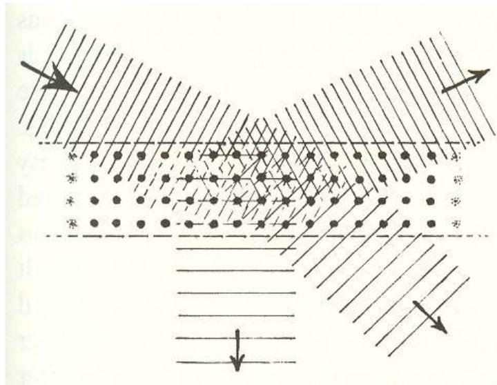
Figura 3.18. Esquema de la difracción de rayos X por un enrejado cristalino.
