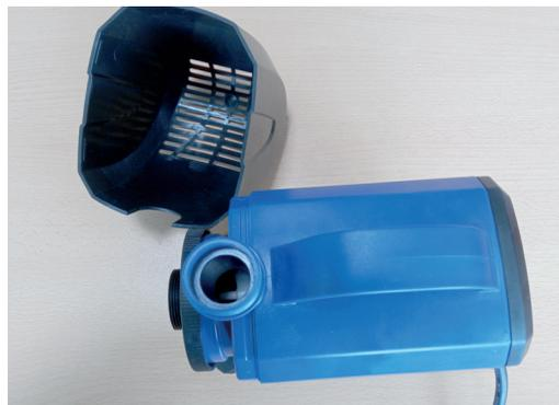
Figura 30. Bomba abierta para la revisión de limpieza
