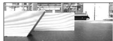
Corte a doble inglete (cara-canto) y corte a inglete simple en cara
