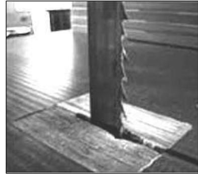
**4- CINTAS DE SIERRA:** fleje de acero provisto de un dentado encargado de cortar las fibras de la madera y posteriormente evacuar los residuos producidos. Se clasifican según el perfil de los dientes.
