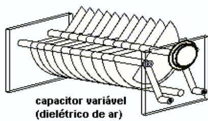
Figura 40: Estrutura física de um capacitor ajustável.
