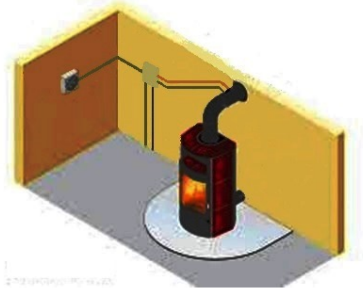
Şekil 5- Katı yakıt yakan cihazın otomatik basınç kontrol adaptörü ile uygulaması
