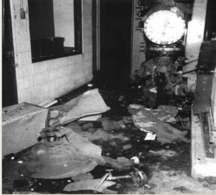
Şekil 6.2. Pompanın her iki tarafında vanaların kapalı olması nedeniyle patlama
