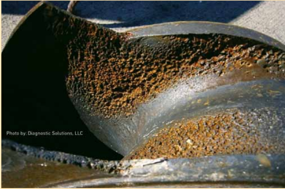
Şekil 5.10. Çark üzerinde kavitasyon hasarı
