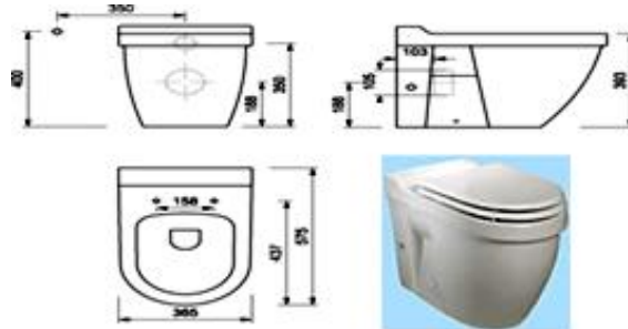
Şekil 10.7. Ayaksız klozet montaj ölçüsü
