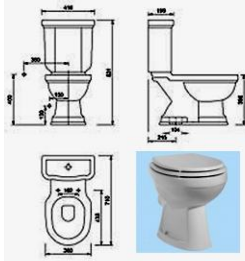
Şekil 10.5. Alttan çıkışlı klozet montaj detayı
