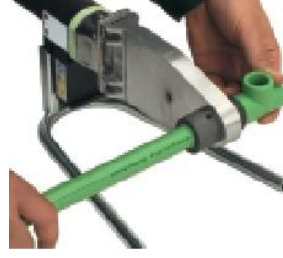
b- Boru ve fittings ütüde ısıtılarak eritilir
