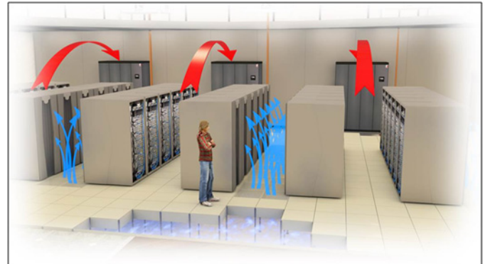
Sıcak ve soğuk koridorlu kurulum ve besleme sıcaklığı kontrolü
