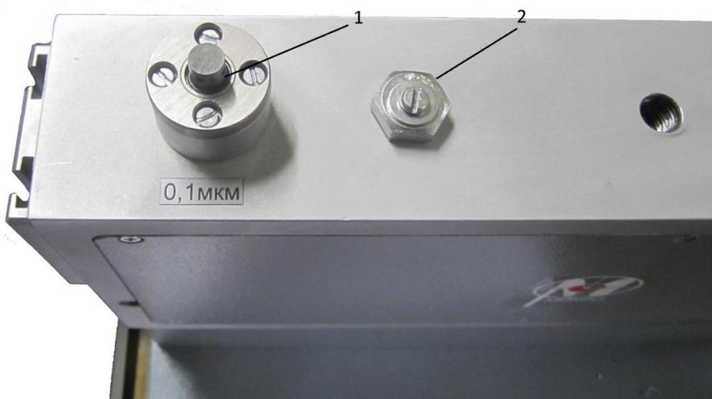
Рис. 2.1. Вид прибора с установленным стопором.
