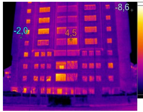
Şekil-45. Yalıtım sonrası arka alt termal ölçümü
