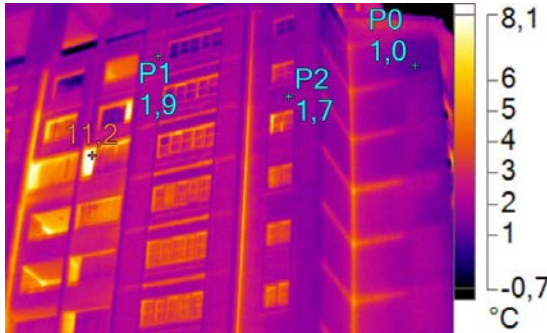
Şekil-42. Yalıtım öncesi arka üst termal ölçüm
