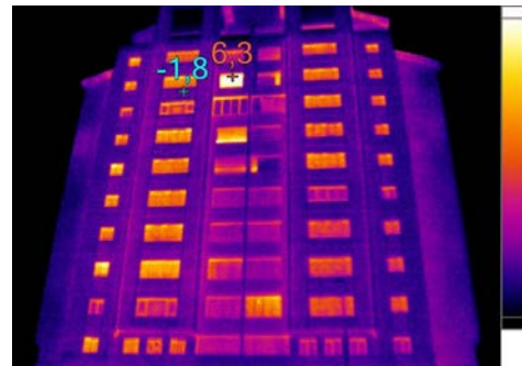
Şekil-43. Yalıtım sonrası arka üst termal ölçümü
