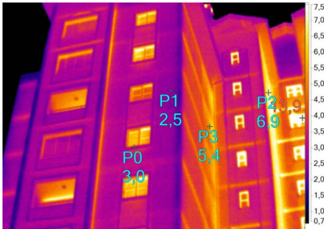
Şekil-10. Yalıtım öncesi ön sol üst termal ölçümü
