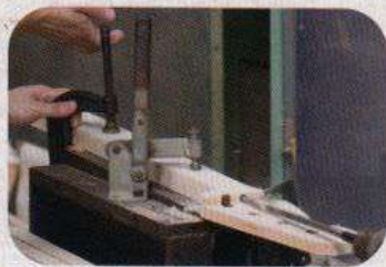
◎トラスロッドの埋め込みも手作業だ。
