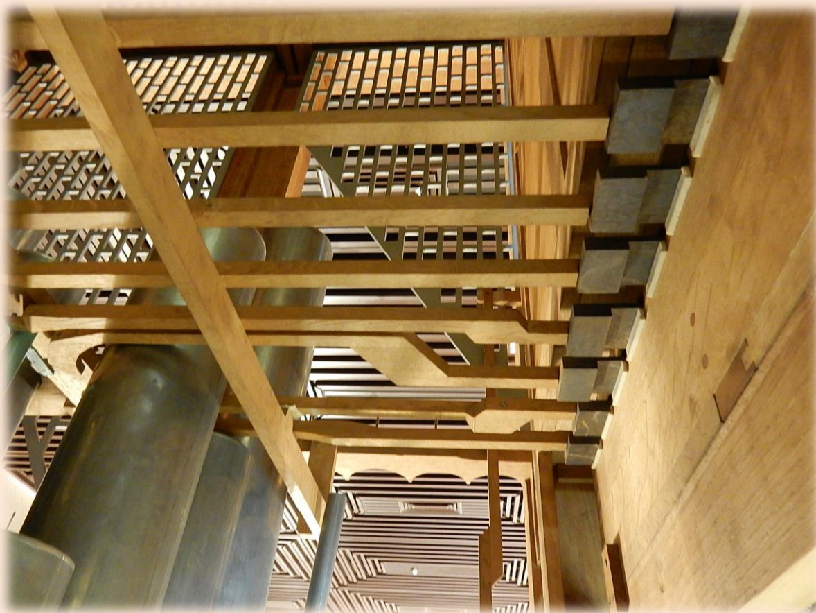
registertraktuuromleiding langs pijpwerk / mechanical stop action around pipes / Registertraktur wird bei Pfeifen umgeleitet
