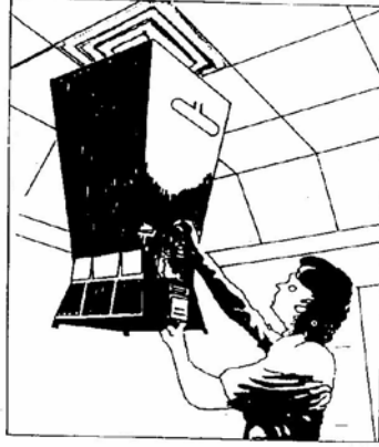
Şekil 6.3. Akış Ölçüm Davlumbazı
