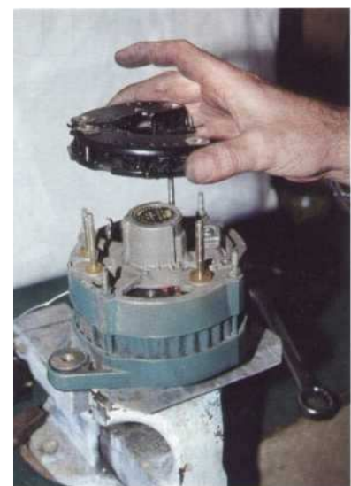
5 Déposez, le pont de diode, dévissez les vis d'assemblage des paliers, puis séparez les paliers.
