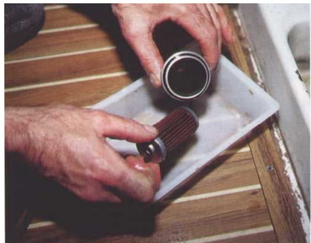
4 Retirez l'élément filtrant. Prévoyez pour ce faire, un petit récipient afin de récupérer le gazole et le filtre.
