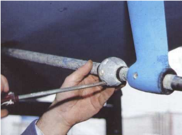
4 Afin de présenter correctement le demi-tube, déposez l'anode puis repoussez la bague.
