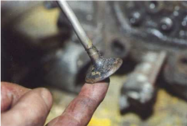
17 A ce stade de corrosion et d'usure, il est préférable de changer les soupapes et de rectifier ou de changer les sièges sur la culasse.
