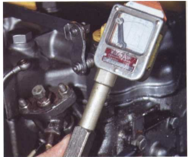
5 Installez le capteur à la place de l'injecteur, serrez la bride.
