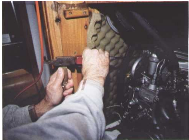
2 Sur un moteur Yanmar, comme sur la photo, frappez légèrement sur l'écrou du filtre avec un burin et un marteau pour le dévisser. Pour les autres marques dévissez la cartouche avec la clé à filtre.
