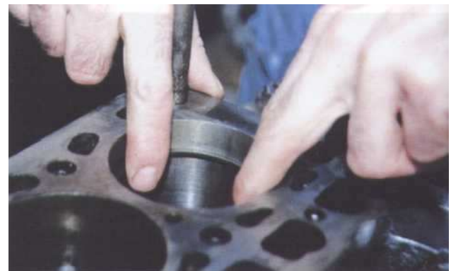
3 Introduisez dans le cylindre en dessous de la cote d'usure les segments pour vérifier le jeu à la coupe.
