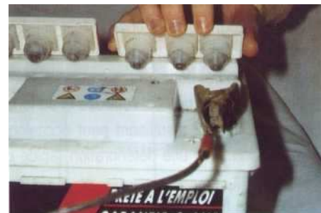
3 N'oubliez pas d'enlever les bouchons lors de la recharge de la batterie.
