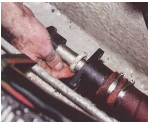
7 Engagez les anneaux dans le presse toupe. Faites attention décalez les coupes afin d'éviter un passage direct d'eau de mer.
