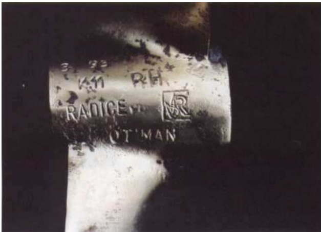
9 - 10 Après un bon nettoyage apparaît le nom du fabricant, le sens de rotation,
