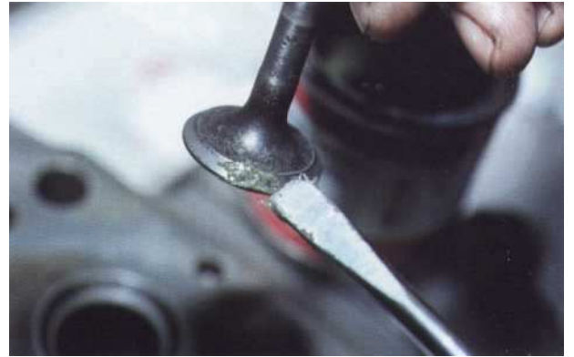
14 Pour roder une soupape, vous devez enduire sa portée avec de la pâte à roder. Utilisez de préférence du gros grain avant de passer au grain fin.
