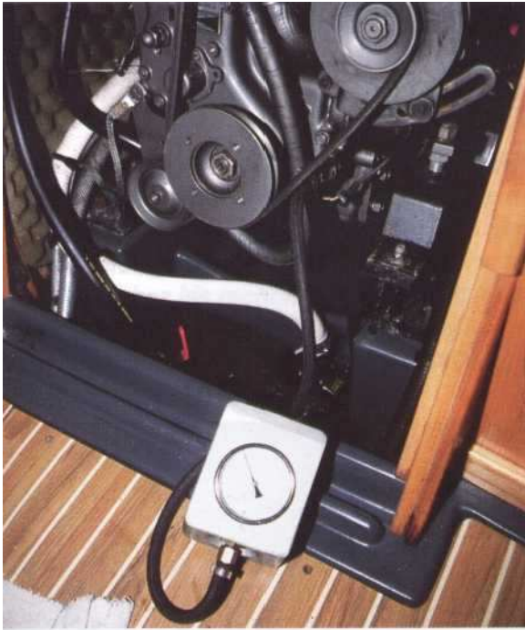
3 Effectuez le relevé à froid, à chaud et moteur embrayé à tous les régimes.
