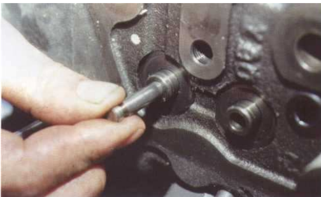
10 La queue de la soupape est soumise à l'usure de même que le guide. Pour vérifier le degré d'usure, enflez la soupape dans son guide tout en la maintenant ouverte et levée d'un centimètre environ. Si vous pouvez remuer latéralement la soupape et que vous sentez du jeu, la queue de la soupape ou le guide sont usés. Répétez l'opération avec une soupape neuve. Si le jeu a disparu, la queue de la soupape est usée, dans le cas contraire, c'est le guide qui est usé.
