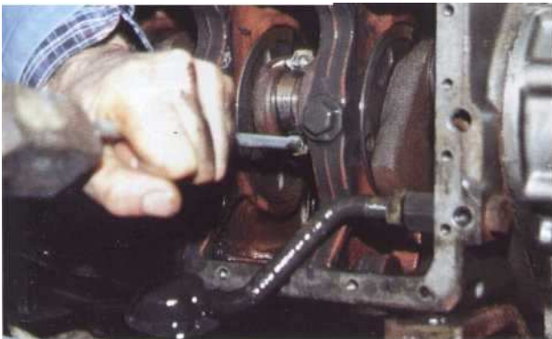
5 Chassez ensuite l'ensemble bielle-piston vers le haut du cylindre.
