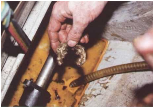
3 Enlevez une à une les anciennes garnitures à l'aide d'un tire-bouchon ou d'un petit crochet.
