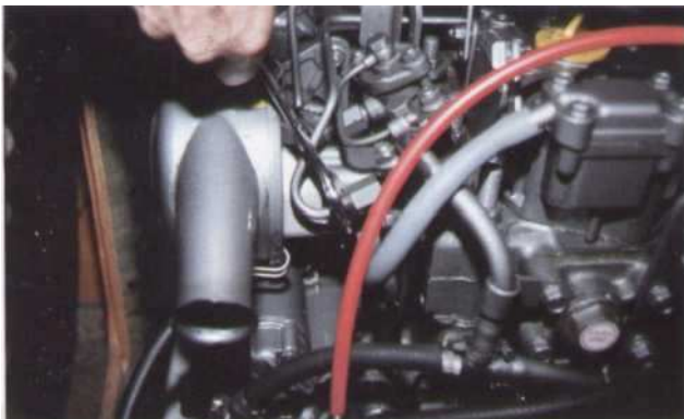
1 Desserrez d'un tour le tuyau haute pression et enregistrez auditivement la baisse de régime.
