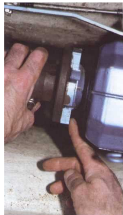
2 Reculez l'arbre d'hélice et vérifiez qu'il occupe bien une position médiane par rapport au tube d'étambot. Rapprochez et emboîtez le tourteau de l'arbre contre celui de l'inverseur en laissant un léger espace pour permettre le passage d'une cale d'épaisseur.
