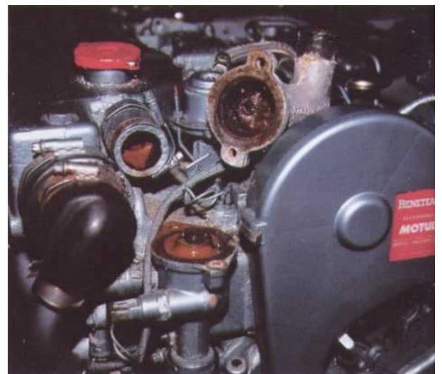
2 Décollez la cloche à l'aide d'un maillet puis dégagez le thermostat. Examinez l'intérieur de la durit. Si le caoutchouc est craquelé ou très entartré, changez-la.
