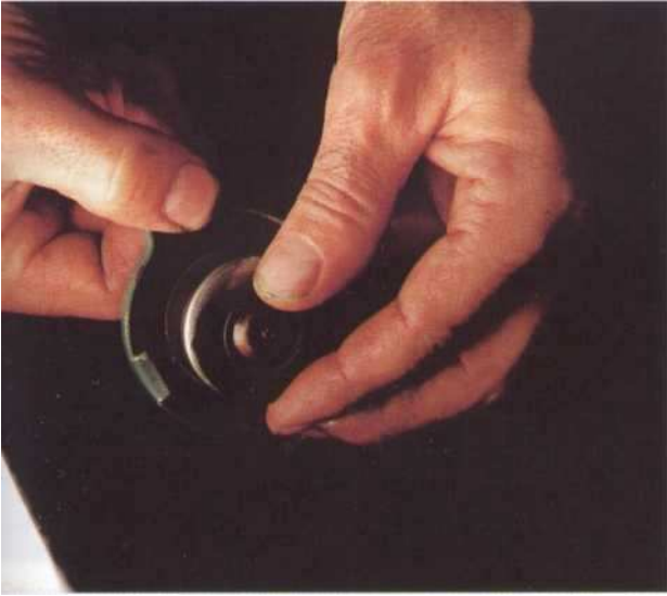
3 Vérifiez l'état du joint, s'il est craquelé ou déformé n'hésitez pas à changer le bouchon.
