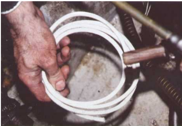
5 Au niveau des tresses, deux choix possibles. La tresse vendue au mètre et la tresse déjà coupée au diamètre de votre arbre. Cette dernière a l'avantage d'être prête à l'emploi
