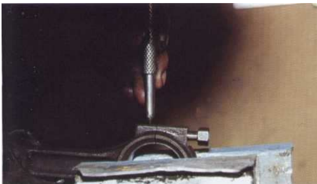
7 Les chapeaux et les bielles, sont frappés d'origine. Si ce n'est pas le cas, repérez vous-même ces éléments.
