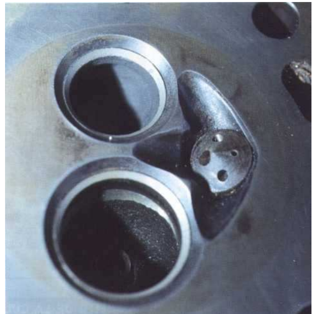
16 La surface de la portée après nettoyage doit être d'un gris satiné uniforme. Aucune trace de corrosion de piqûre ne doit subsister.
