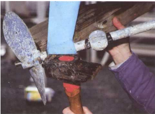
5 Opération plus délicate. Décoller l'hélice, Il faut être deux. Un bon marteau, une grosse cale bien lourde pour « tenir coup derrière ». Tapez maintenant avec conviction au bon endroit, c'est à dire sur l'arrière du moyeu.
