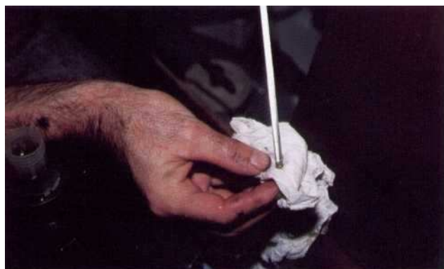
10 attendez quelques minutes puis vérifiez le niveau de l'huile après avoir fait tourner le moteur quelques instants. Faites l'appoint si nécessaire.
