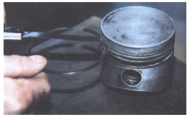
2 Pistons parfaitement nettoyés, contrôlez le jeu des segments dans leur gorge à l'aide d'un jeu de cale.
