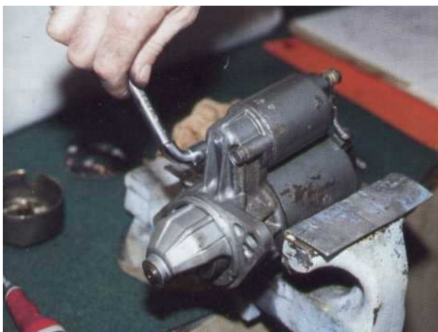
3 Débranchez le câble de l'inducteur puis dévissez les deux vis de fixation pour déposer le solénoïde.
