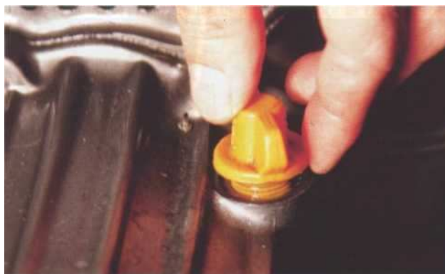
3 Le contrôle du niveau se fait jauge en appui non vissée sur l'inverseur.
