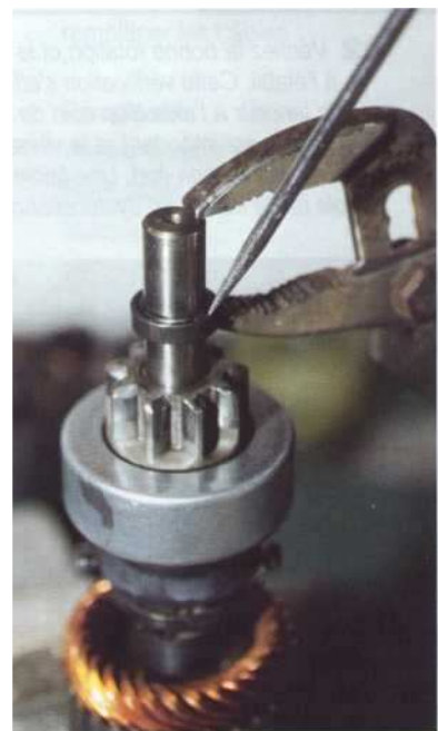
20 Montez en force la butée sur le circlip en se servant d'une ou de deux paires de pinces.
