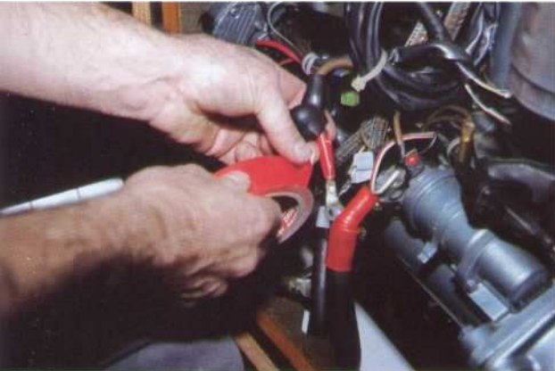
4 Le ruban adhésif permet un repérage efficace.
