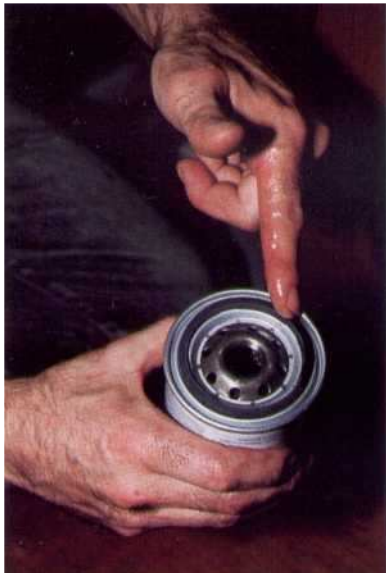
6 Lubrifiez le joint en caoutchouc du filtre avec un peu d'huile neuve. N'oubliez pas de nettoyer aussi la portée du plan de joint sur le bloc moteur.
