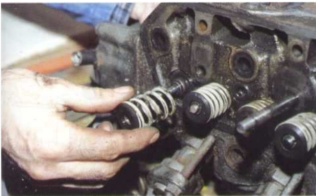
3 Après avoir décomprimé le ressort, dégagez l'ensemble cuvette, ressort, rondelle d'appui.
