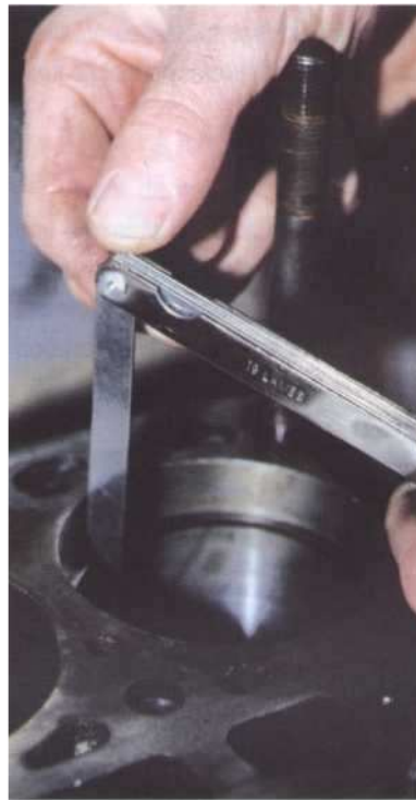
4 La mesure s'effectue avec un jeu de cales,
