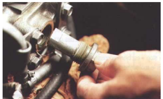
4 Après avoir changé l'anode revissez puis bloquez celle-ci sur le bloc moteur.
