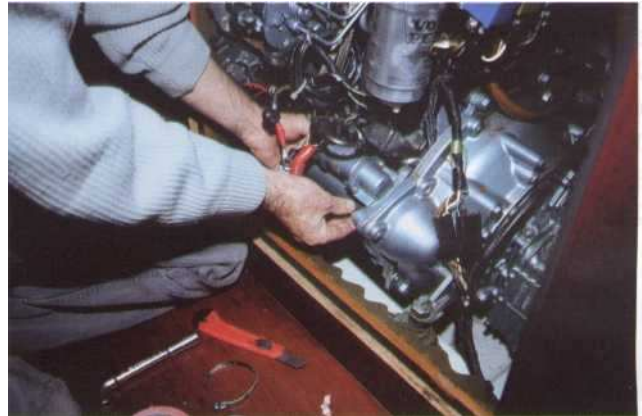
5 Les connexions électriques étant toutes débranchées, vous pouvez maintenant dévisser les vis de fixation du démarreur.
