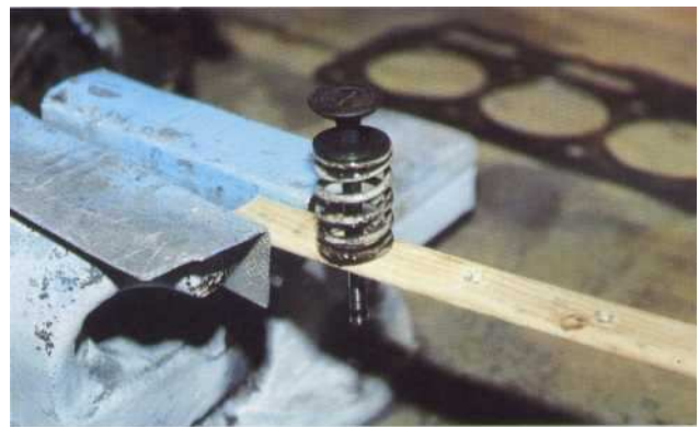
4 Installez la soupape et l'ensemble cuvette, ressort, rondelle sur un support pour repérer leur emplacement d'origine afin de les remonter au même endroit. Ici, les soupapes sont installées sur une lame en bois, percée de huit trous dont on a pris soin de repérer le côté du cylindre N° 1 (coté volant moteur) par une flèche.
