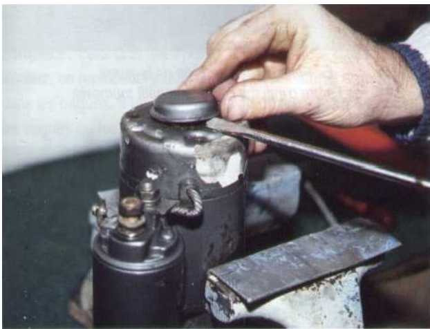
1 Serrez le démarreur dans un étau puis déposez le cache poussière.
