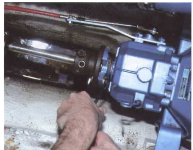
6 Revérifiez une dernière fois le parallélisme après le serrage des pattes puis revissez les boulons du tourteau.
