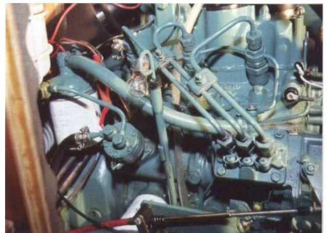
3 Branchez une lampe témoin en série entre le fil d'alimentation et la bougie.
