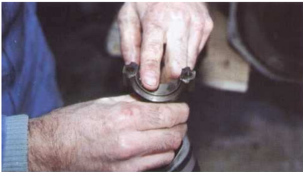
11 Lubrifiez les coussinets et les manetons.
