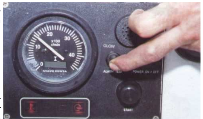
Actionnez la clé ou le bouton faisant office de contact. Les voyants de pression d'huile et de charge doivent s'allumer. Préchauffez puis actionnez le démarreur. Le moteur doit démarrer au bout de quelques secondes et tous les voyants s'éteindre.
