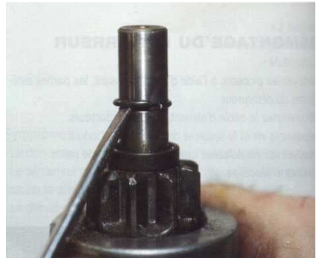
6 Faites glisser le circlip de la gorge de l'arbre d'induit à l'aide d'un petit tournevis.
