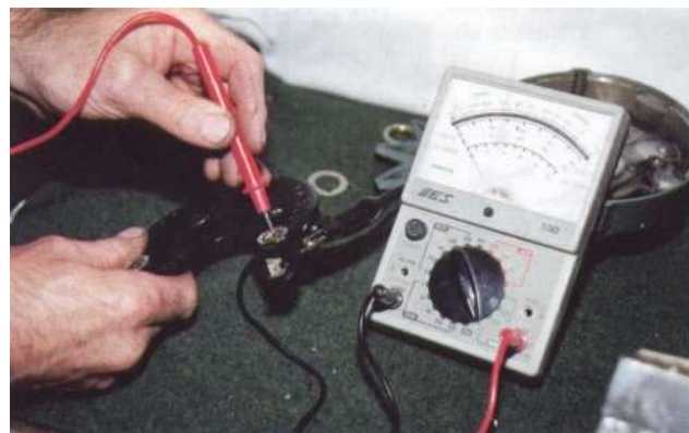
8 Contrôle du pont de diodes. Placez une touche de l'ohmmètre sur le support des diodes et l'autre sur chacune des touches de sortie. Inversez les touches de l'ohmmètre et répétez l'opération. Le courant ne doit passer que dans un seul sens.
