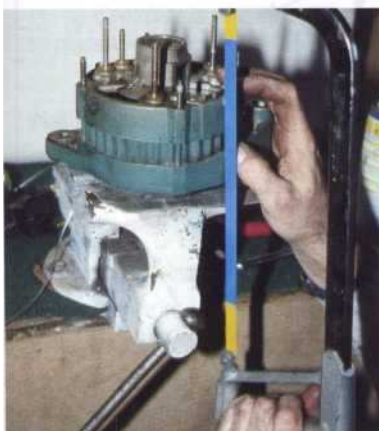
2 Avant de désassembler l'alternateur, effectuez des repères d'alignement des paliers. Sur la photo, un petit coup de scie nous permettra de positionner les pièces correctement lors du réassemblage.
