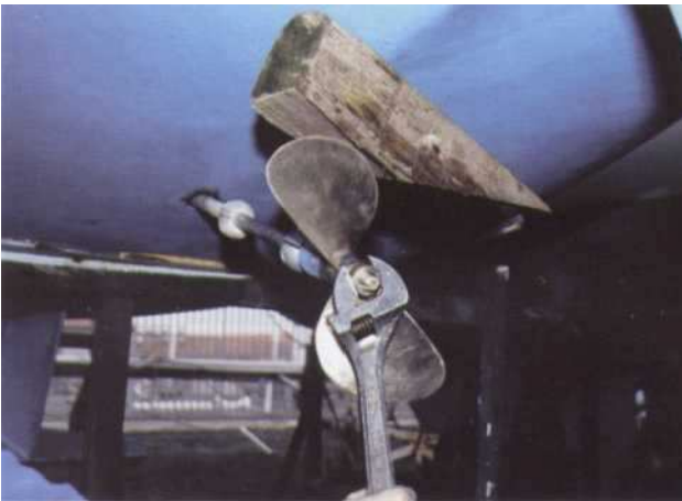
1 1 Reposez la clavette après vous être assuré de son bon état. Celle-ci ne doit pas être ni déformée ni marquée. Reposez l'hélice, vissez l'écrou sur un nouveau frein, puis bloquez l'hélice en procédant de la même façon que lors du déblocage.
