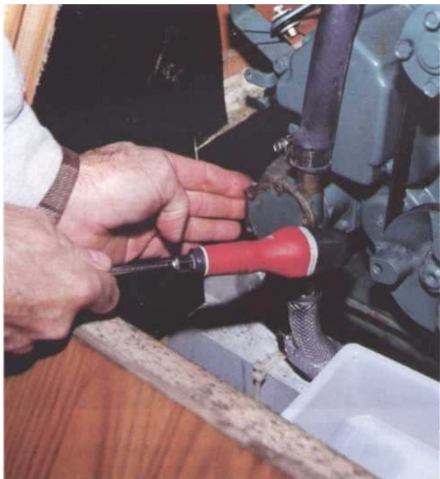
3 Tapez latéralement avec le manche du tournevis ou à l'aide d'un maillet pour décoller la plaque. N'introduisez jamais la lame du tournevis entre les plans de joint.
