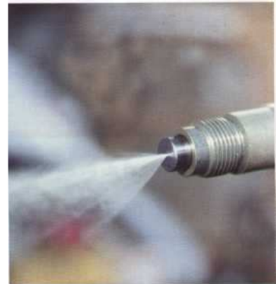
7 Vérifiez la qualité du jet en provoquant rapidement l'injection. Le jet doit être régulier, uniforme, symétrique. Dans le cas d'un injecteur à trous, vérifiez bien que tous les trous débitent.
