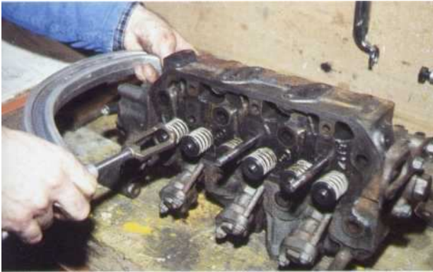
1 Pour effectuer la dépose des soupapes, utilisez un démonte-soupape. Frappez en premier lieu au maillet sur le bord des cuvettes supérieures afin de décoller les clavettes.
