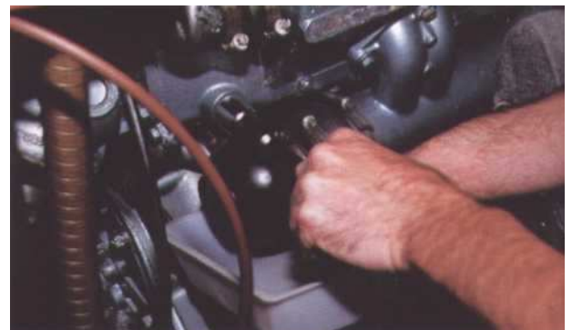
2 Dévissez la vis, placez un récipient SOUS l'orifice de vidange afin de modifier la trajectoire du jet et limiter les salissures.
