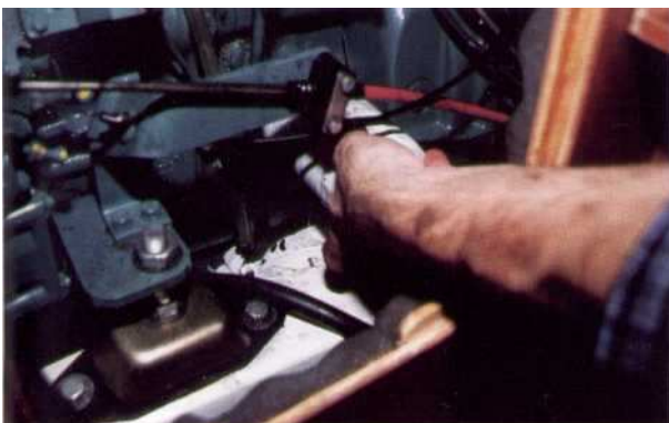
7 Ne serrez jamais le nouveau filtre à l'aide de la clé, mais vissez-le à la main jusqu'à ce qu'il rentre en contact avec le bloc moteur. Puis faites ensuite un demi à trois quarts de tour supplémentaire.
