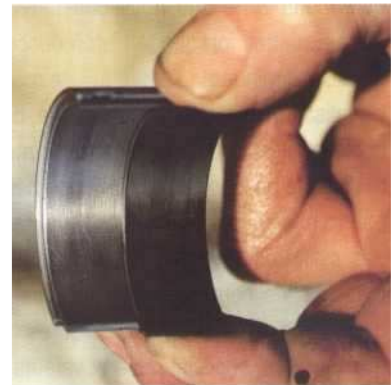
8 L'examen des coussinets laisse apparaître la couche de métal rose, signe d'une usure prononcée.
