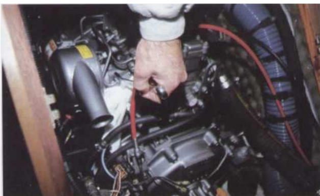
3 Lorsque vous resserrez le tuyau, le moteur doit reprendre son régime initial.
