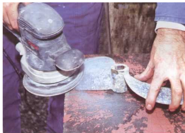
8 Nettoyez l'hélice. C'est facile, rapide, si vous utilisez une ponceuse orbitale.
