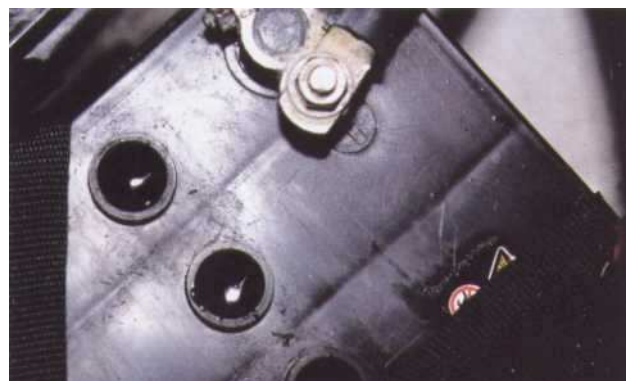
3 Vérifiez bien que chaque élément de la batterie soit recouvert d'environ 1 cm à 1,5 cm d'eau distillée.
