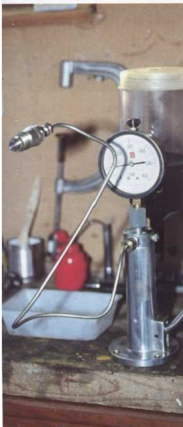
6 Montez l'injecteur sur la pompe d'essai. Montez lentement en pression et relevez la pression au moment où l'injection débute. Si la pression relevée est plus basse que celle prescrite par le constructeur. Rajoutez des cales sur le ressort. Dans le cas contraire enlevez des cales. La pression d'injection varie de 10 bars/cm pour une variation d'épaisseur de cale de 0,1 mm.
