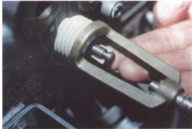
20 Remontez les soupapes en positionnant bien sûr chacune d'elle sur le siège sur lequel elles ont été rodées. Remontez les ressorts, les coupelles et les clavettes à l'aide du démonte-soupapes.
