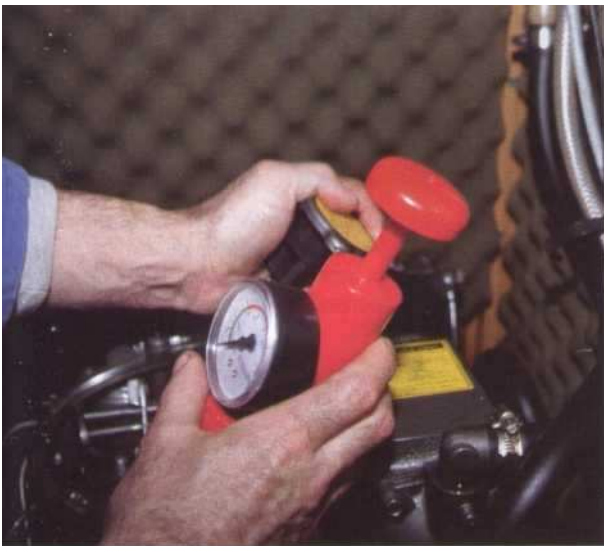
5 Un contrôleur de refroidissement vous permet de mettre artificiellement le système de refroidissement sous pression. Bien utile pour repérer les petites fuites.
