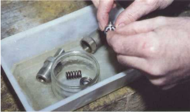
2 Séparez les différentes pièces dans un bac propre, rempli de gazole.
