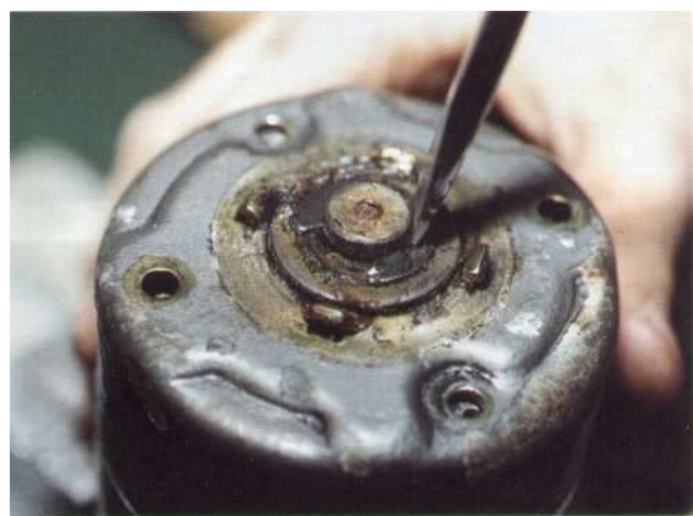
2 Enlevez le circlip et la rondelle de butée. Attention à ne pas perdre la rondelle et la cale d'épaisseur. Déposez ensuite les deux vis fixant le flasque arrière ainsi que celles fixant le porte charbon.
