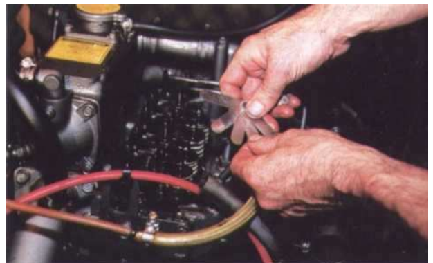
3 Avant de contrôler et de régler le jeu au soupapes, repérez les soupapes d'admission et celles d'échappement. Choisissez la cale qui correspond à la valeur de réglage.
