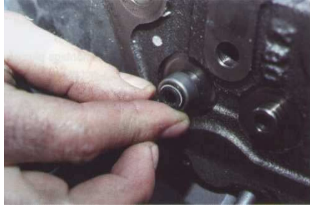
18 N'oubliez pas de remonter des joints neufs de queue de soupape.
