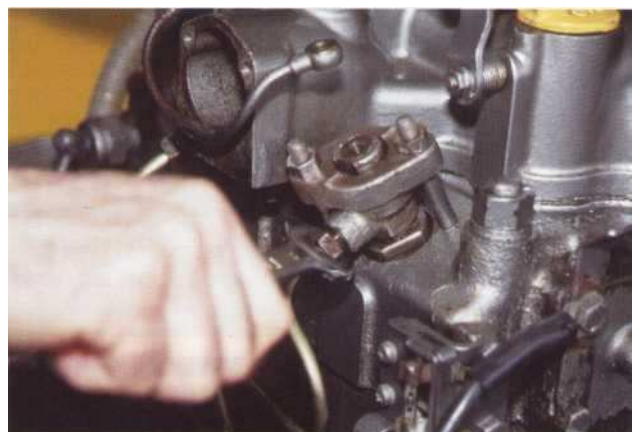
3 Débloquez le tuyau haute pression avant de desserrer la bride maintenant l'injecteur.
