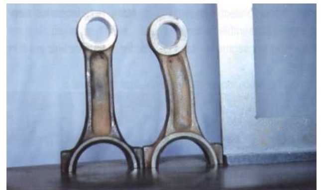
6 Ici, pas besoin d'instrument de mesure pour constater que la bielle est tordue.
