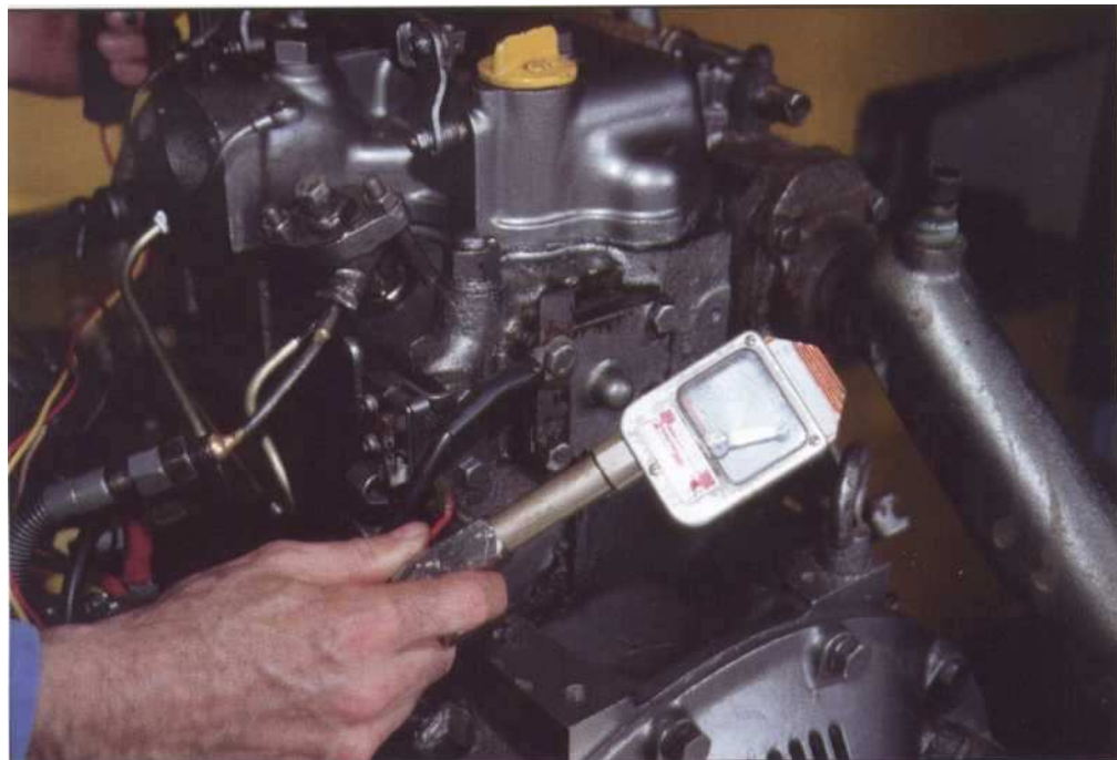
6 Actionnez le démarreur. Il est préférable durant cette opération de vous faire aider pour actionner la clé de contact. Dans le cas où vous n'avez démonté qu'un seul injecteur pour ne contrôler qu'un cylindre, tirez sur l'arrêt moteur afin d'empêcher le moteur de démarrer sur les cylindres restants.
