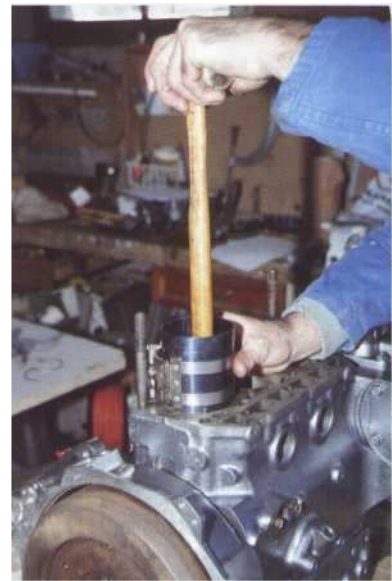
12 Présentez l'ensemble sur le cylindre correspondant et poussez le piston avec le manche d'un marteau. Ne forcez jamais, guidez la bielle vers son maneton pour éviter d'érafler les parties rectifiées.
