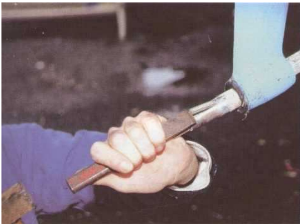
7 Encore une operation bunnimarteau pour degager la clavette.
