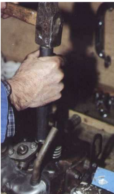
5 Même si vous ne disposez pas d'un démonte-soupape, il est tout à fait possible de procéder à l'opération en frappant avec un gros marteau sur un tube disposé sur la cuvette supérieure de la soupape.
