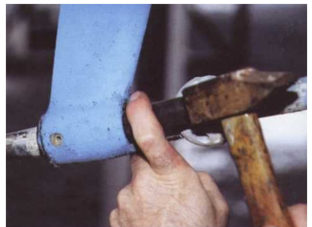
3 Etape plus délicate, extraire la bague. Un demi-tube d'un diamètre intérieur égal au diamètre de votre arbre permet de repousser facilement la bague. Un tournevis peut tout aussi bien faire l'affaire.
