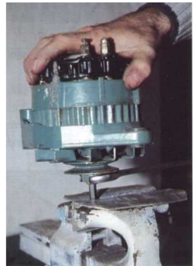
3 Pour déposer la poulie, immobilisez l'axe à l'aide d'une clé polygonale mâle serré dans un étau ou immobilisez la poulie à l'aide d'une courroie usagé serré elle aussi dans un étau, desserrez l'écrou.
