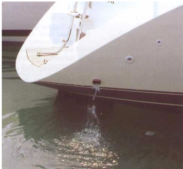
5 Lorsque le liquide quatre saisons commence à s'évacuer par l'orifice d'échappement, arrêtez le moteur. Votre moteur est alors protégé.
