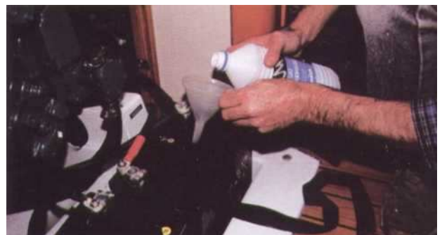
2 Si le niveau de l'électrolyte est insuffisant, ajoutez exclusivement de l'eau distillée ou déminéralisée. Utilisez à cet effet un petit entonnoir afin d'éviter de mettre de l'eau un peu partout au moment du remplissage.
