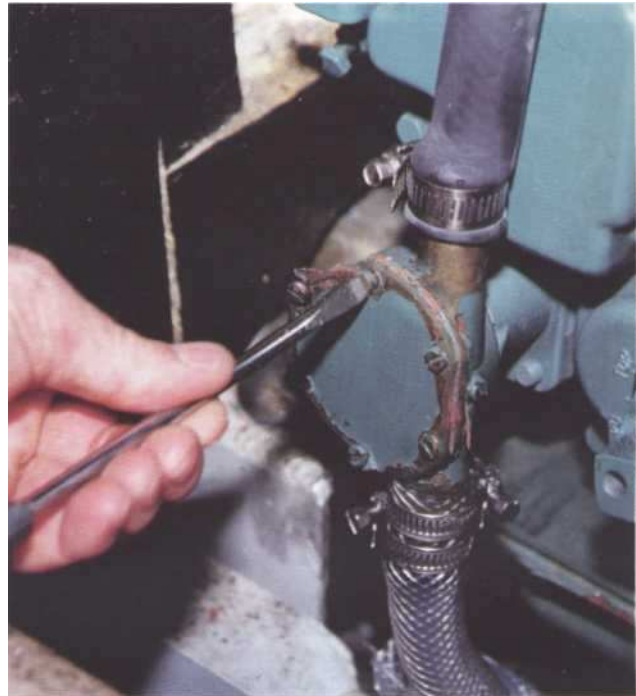
2 Tapez sur le tournevis à l'aide d'un maillet pour assurer l'empreinte. Dévissez les vis en maintenant la plaque de la pompe à eau.
