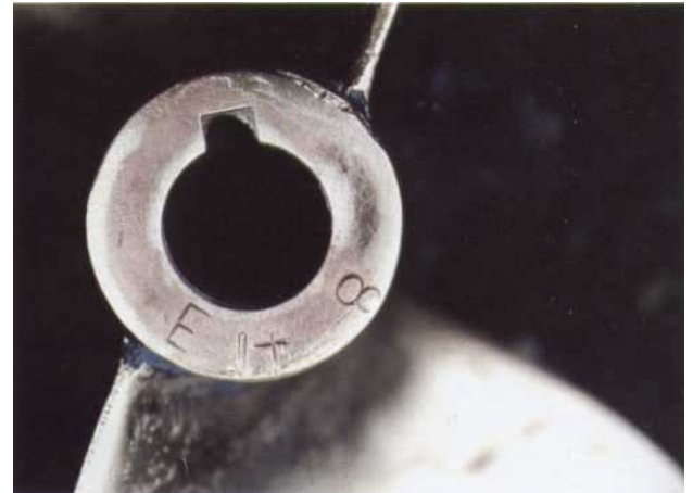
le diamètre, le pas. Toutes les indications qu'il faut donner si vous changez l'hélice.
