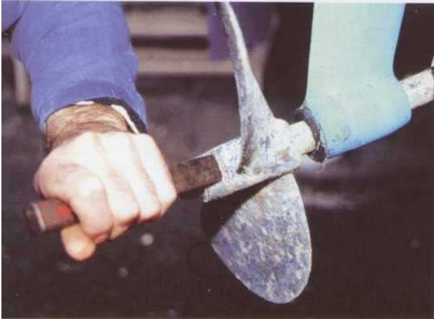
3 Rabattez le frein d'écrous d'hélice à l'aide d'un marteau et d'un burin
