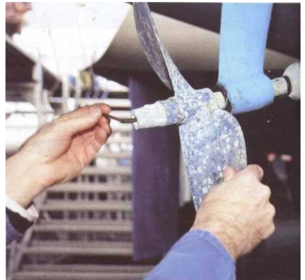
1 Dévisser en premier lieu l'anode. Son blocage est assuré par une vis polygonale mâle. Utilisez une clé Allen.
