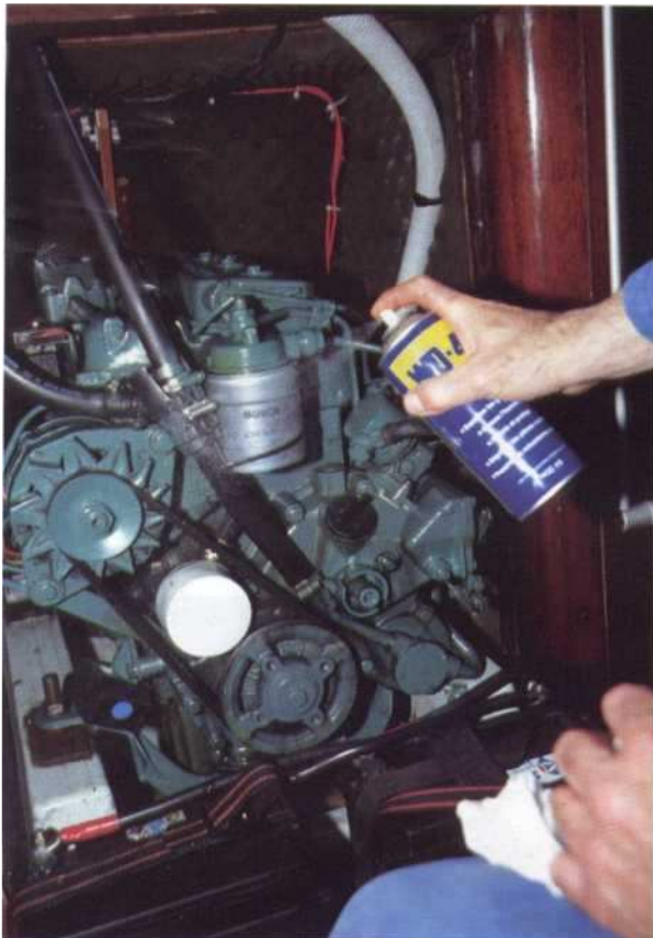
La pulvérisation de WD 40 protège efficacement votre groupe propulseur des attaques de la corrosion.
