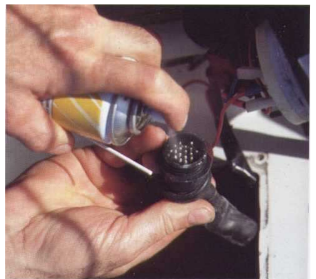
Déconnectez le faisceau et pulvérisez du WD 40 ou équivalent.
