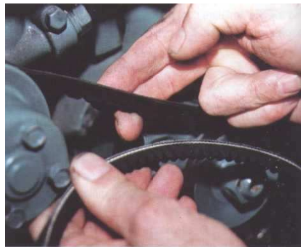
2 Examinez particulièrement les flancs de la courroie. Une courroie insuffisamment tendue patine et s'use.
