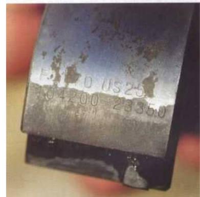
9 Le marquage des coussinets s'effectue sur l'envers de la coquille. Std pour cote standard ou 0,10 - 0,20 pour la cote de rectification.
