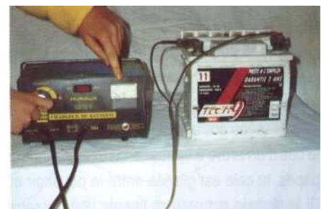
4 Ne dépassez pas l'intensité de charge. Exemple: batterie de 45 Ah = maximum admissible 9 A.
