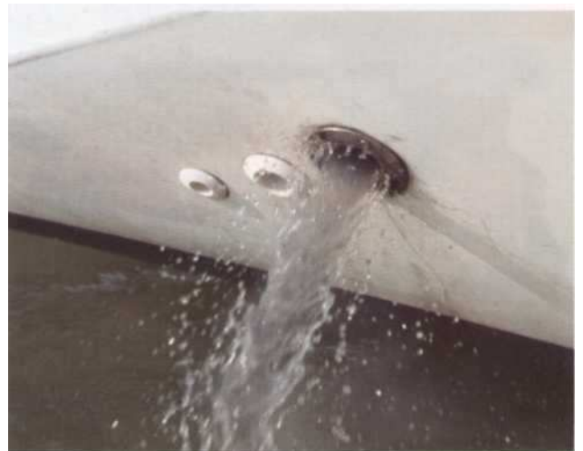
Vérifiez le bon fonctionnement de la pompe à eau à l'arrière du bateau.
