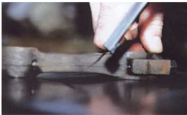
5 Une vérification rapide de l'alignement des bielles peut se faire en les posant sur un marbre.
