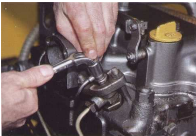
1 Débloquez en premier lieu la vis de retour de gazole situé sur l'injecteur.
