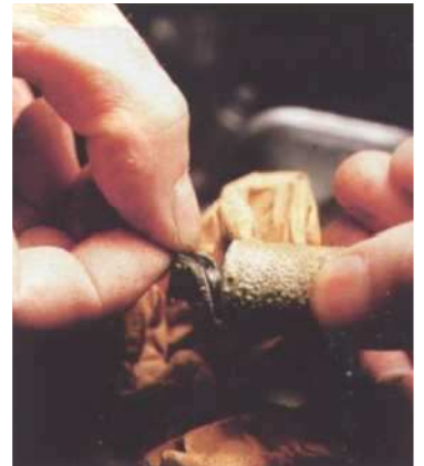
2 Dévissez l'ancienne anode de son support. Veillez à récupérer son joint d'étanchéité (Yanmar)
