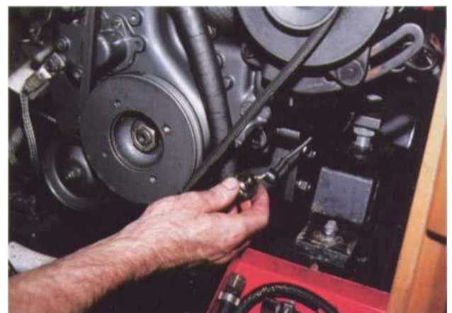
2 Une fois le mano-contact déposé, installez à sa place l'adaptateur du contrôleur.
