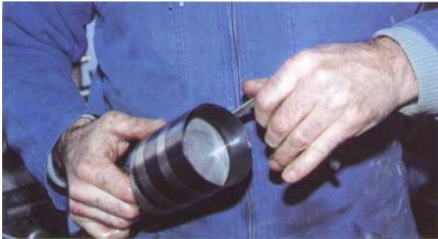
10 Lorsque les segments sont installés sur le piston et que la bielle a été remontée, les segments doivent être comprimés dans leur gorge pour permettre au piston de rentrer dans le cylindre. Faites attention à ne pas faire tourner les segments durant cette opération.
