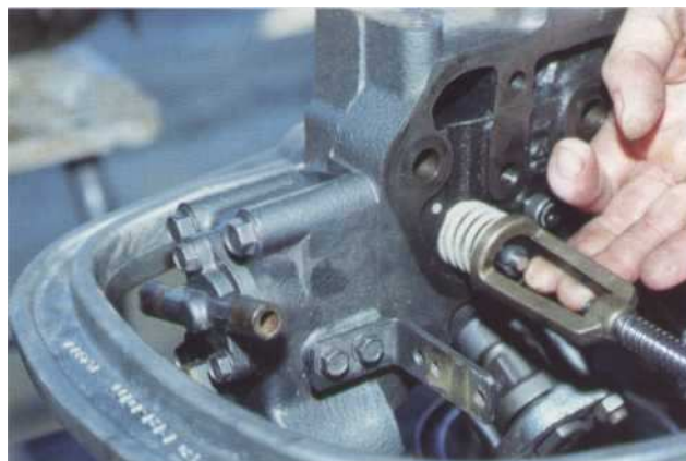
21 Veillez à bien positionner les clavettes dans leur logement. Frappez ensuite au maillet sur les queues de soupape pour s'assurer du parfait montage des clavettes dans leur logement.
