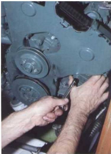
3 Desserrez l'axe de pivotement, la vis ou le boulon du tendeur.
