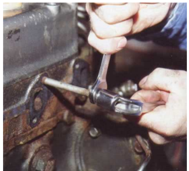
2 Pour enlever la tige filetée, vissez deux écrous l'un contre l'autre, puis dévissez celui du dessous.
