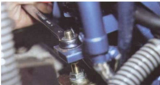
6 Alignement en hauteur. Ajustez la hauteur des pattes (voir schéma). Dévissez ou vissez par petites touches et contrôlez le parallélisme des tourteaux pour chaque variation de hauteur. Alignement latéral. Déplacez très légèrement le moteur sur un bord ou sur l'autre. Bloquez ensuite les écrous et les contre- écrous des pattes une fois l'alignement terminé. Si l'alignement est impossible à réaliser trois causes sont possibles : tourteaux voilés, arbre d'hélice flambé, chaise moteur faussée.
