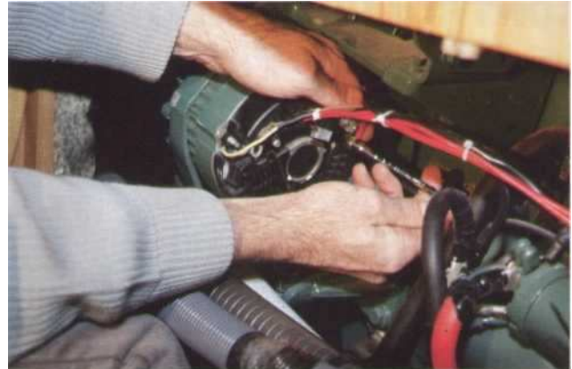
2 Déconnectez ensuite chacun des fils. Revissez les écrous sur leurs vis respectives.
