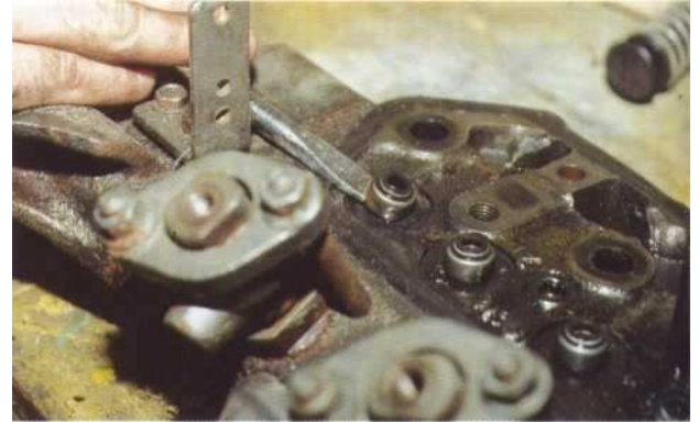
8 Déposez le joint de tige de soupape en faisant lever avec un tournevis.
