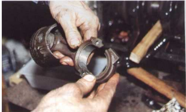
6 Remarquez le sens d'assemblage, ergotage contre ergotage.
