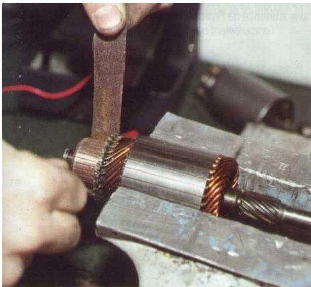
1 0 Vérifiez si la surface du collecteur, la nettoyer avec du papier de verre, grain fin. Si le collecteur est très marqué, il sera nécessaire de l'usiner au tour en respectant les cotes d'usinage données par le constructeur.
