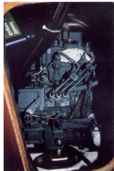
9 Lors du remplissage n'oubliez pas de sortir la jauge d'huile, cela facilitera la descente de l'huile dans le carter.
