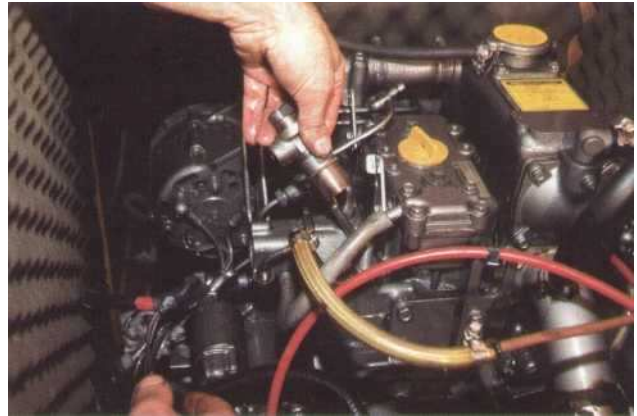
4 Ecartez le tuyau haute pression, dégagez l'injecteur.
