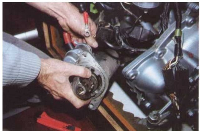
7 Dégagez le démarreur. Attention, le démarreur est un élément très lourd.
