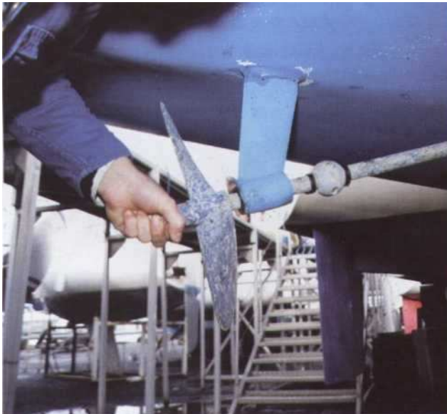
1 Appréciez à la main le jeu de l'arbre sur la bague hydrolube. Remplacez la bague lorsque le jeu est supérieur à 1,5 mm.
