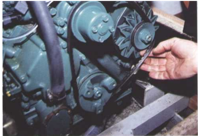
6 Pour déposer la courroie, il est nécessaire de repousser complètement l'alternateur afin de dégager la courroie.
