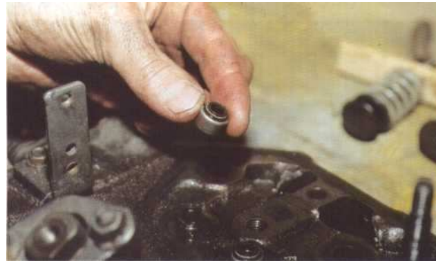
9 Le joint, monte sur la partie supérieure du guide, supprime l'aspiration de l'huile, au temps admission à travers le guide et la queue de la soupape. Il limite donc la consommation d'huile. A ce titre, il doit être remplacé chaque fois qu'il a été déposé.
