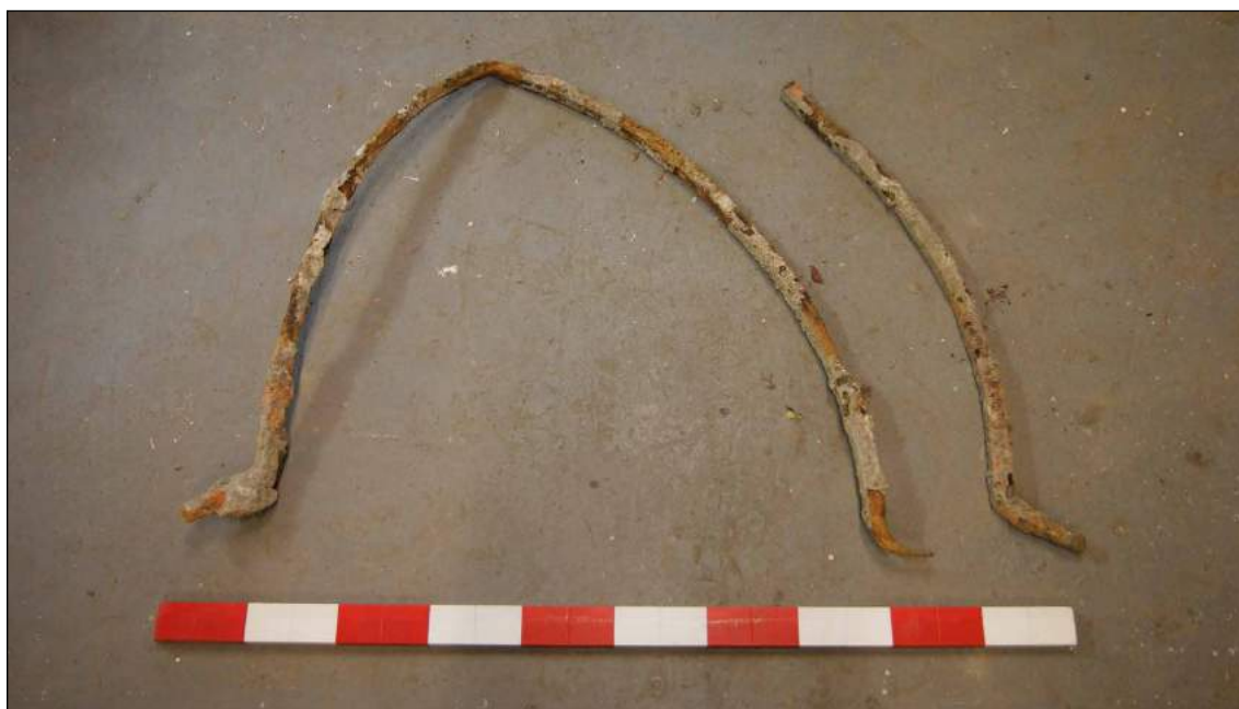
Afbeelding 23. Ijzeren stangen, aanwezig aan de onderkant van de spaarbogen van de schuur.
