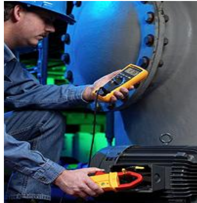
Resim 1.5: Pens ampermetre ile ölçüm yapma
