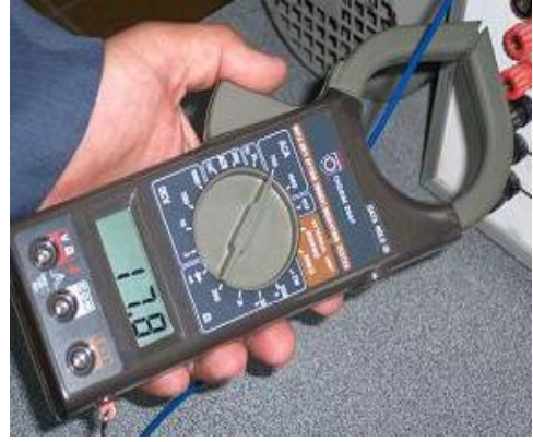
Resim 1.4: Pens ampermetre ile ölçüm yapma
