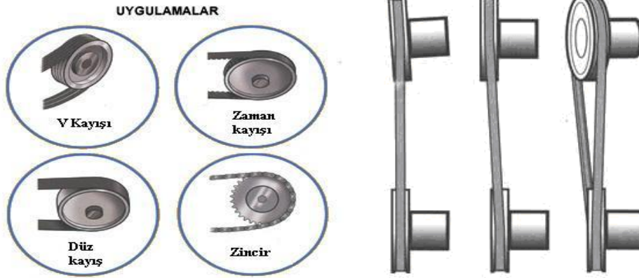
Şekil 2.8: Kasnaklara kayışların yerleştirilmesi
