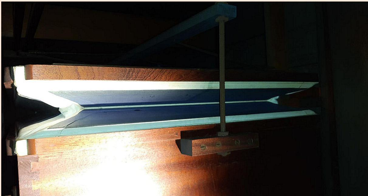
De windvoorziening bestaat uit een klassieke vouwbalg die werd voorzien van drukveren. Alles is op degelijke wijze vervaardigd. De ventilator staat in een geïsoleerde kast onder in het orgel.
