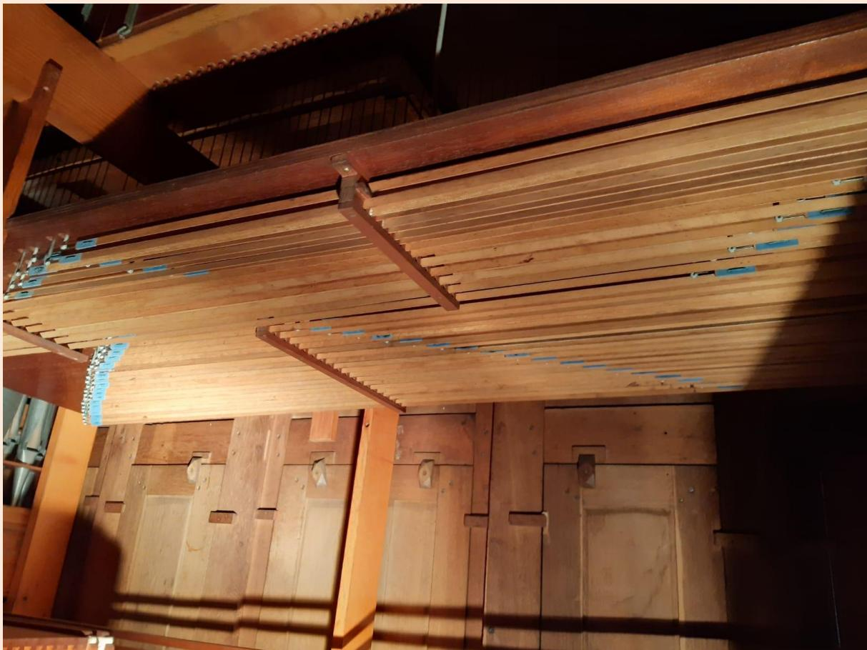
De toetstructuur is op ambachtelijke wijze vervaardigd met houten walsen en ramen, abstracten en fosforbrons en messing vertint draadwerk. De moeren zijn van leder met kernlaken en vilt, de invoeringen zijn van kernlaken.
