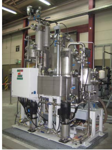
Şekil 6. Soğuk zincir uygulamasında kullanılan resorbsiyonlu soğutma cihazı [33]
