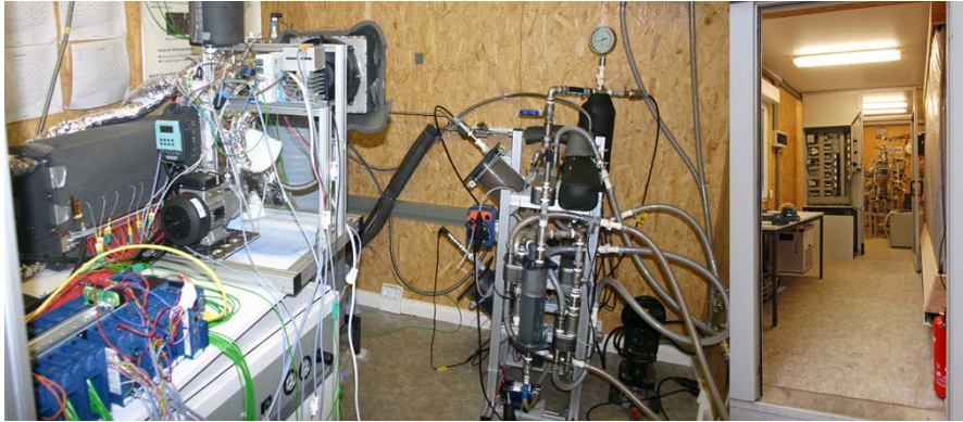
Şekil 5. Atık ısı kaynaklı resorbsiyonlu soğutma sistemi [32]
