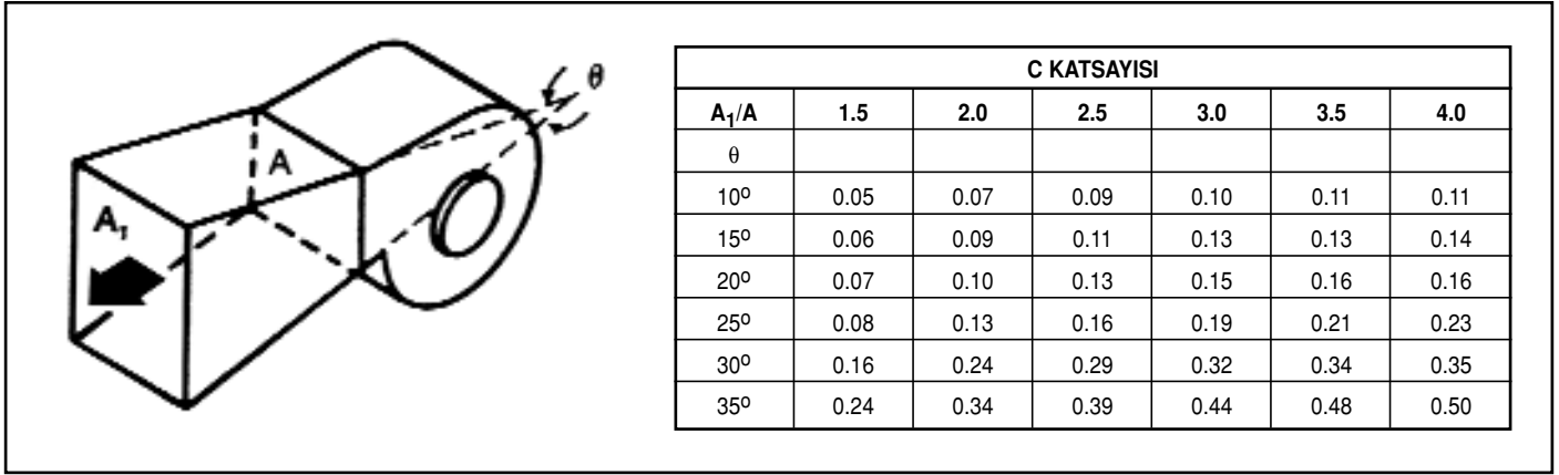
EK 2. Şekil 7. FANA GÖRE SİMETRİK, KENARLAR DÜZ GEÇİŞ PARÇASI
