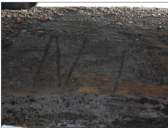
Afb. 37 De aangetroffen merken op de palen. Van boven naar beneden: merk op eiken paal S04 (vermoedelijke datering 1703), merk op eiken paal S04 (vermoedelijke datering 1703), merk op grenen paal S05 (vermoedelijke datering 1758) en merk op grenen paal S01 (vermoedelijke datering 1783).
