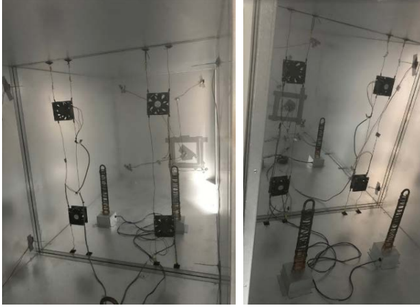
Şekil 7. Elektrikli Isıtıcı, Fan ve İç Ortam Sıcaklık Sensörleri
