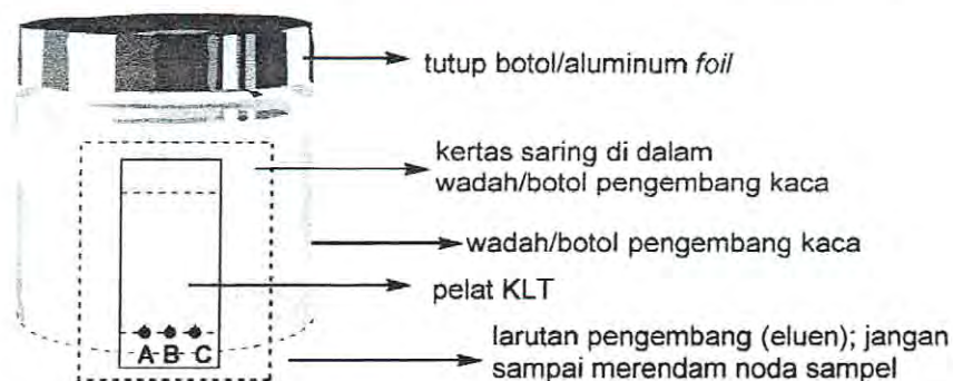
Gambar 3 Cara melakukan elusi pada pelat KLT di dalam botol wadah pengembang KLT
