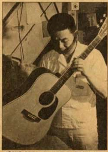
▲ 最終検査：各工程でのチェックを行った後、最終責任者が最終的な総合的検査をして完成品となります。
