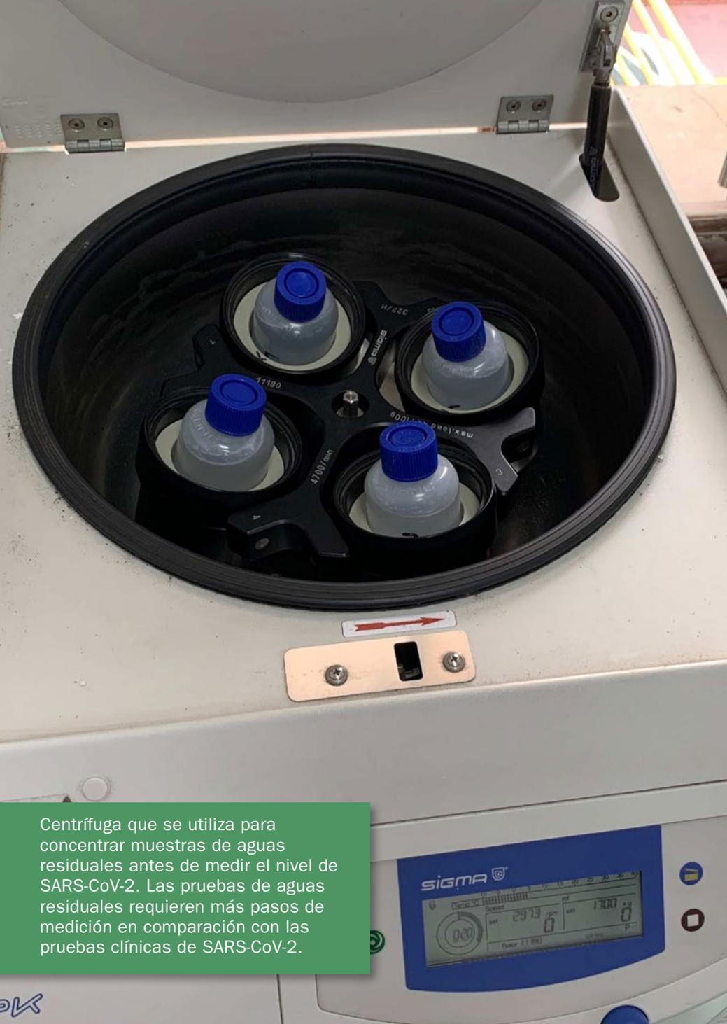
Centrífuga que se utiliza para concentrar muestras de aguas residuales antes de medir el nivel de SARS-CoV-2. Las pruebas de aguas residuales requieren más pasos de medición en comparación con las pruebas clínicas de SARS-CoV-2.
