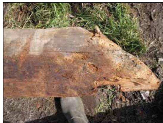
Afb. 57. Zijaanzicht van de oostelijke bovenbalk met schuine kop.
