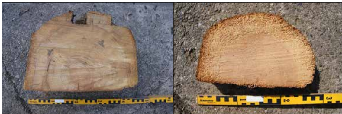
Afb. 49. Twee monsters van elementen van het vierkant, afkomstig van de oostelijke bovenbalk en een van de stijlen.
