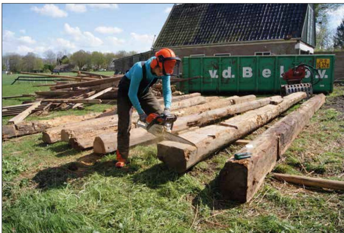
Afb. 63. Van de elementen van het vierkant worden monsters gezaagd met de kettingzaag.
