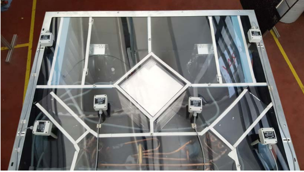
Şekil 5. Deneysel çalışmada kullanılan HRV-HP cihazı üzerindeki sıcaklık nem duyarğaları
