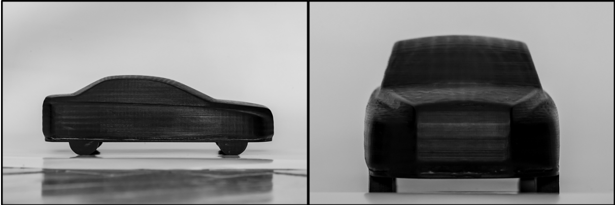
Şekil 9. Üç boyutlu yazıcı kullanılarak basılan araç geometrisi
