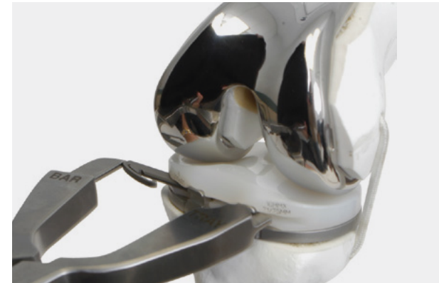
Механизм Biomet Lock прижимает полиэтиленовый вкладыш к основанию большеберцового компонента, предотвращая его микроподвижность
