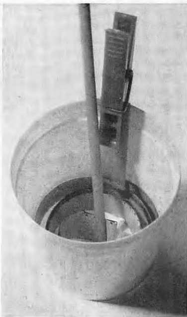
Bild 2. Das einfache Stabentwicklungsgerät besteht aus einem Kunststoff-Senfbecher, einem Vinidurstab und einer Kunststoffklammer mit Verlängerungsstück. Bis 2 m 16 mm breiter Film kann in 50 ml Badmenge bearbeitet werden. Das Gerät eignet sich besonders für Negativentwicklung.
