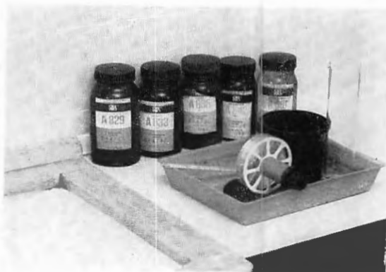
Bild 12. Arbeitsplatz mit umgebauter Entwicklungsdose für Umkehrentwicklung schwarzweiß bis zu einer Filmlänge von 1,7 m.
