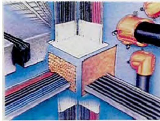
Şaft Boşluklarının Yalıtım Malzemesi ile Doldurulması
