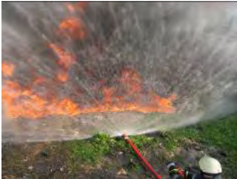
Perdeleme Su İşleme Yöntemi
