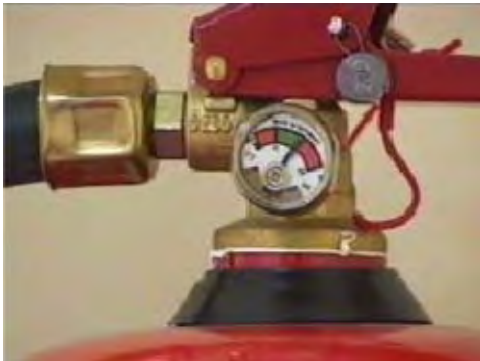
Yangın Söndürme Cihazının Manometresi
