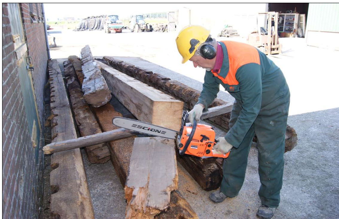
Afb. 51 Het zagen van de houtmonsters uit de elementen van het vierkant.
