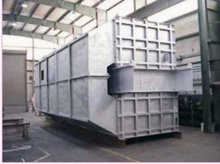
Şekil 4.3. Çelik konstrüksiyonlu havadan havaya 2 geçişli endüstriyel ısı deęiřtirici (MECS Inc.'in izniyle)
