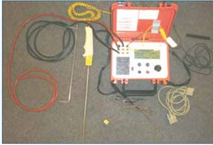
Şekil 1.43. FKT manometre ve aksesuarları (Bill Hunter'in izniyle)
